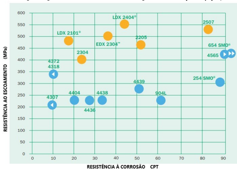
Figura 3 - Relação aços inox austeníticos e aços inox duplex (sp0,2 x corrosão).
