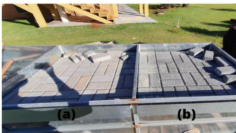
Figura 12: Revestimento bloco de concreto não-poroso (a) e bloco de concreto poroso (b)
