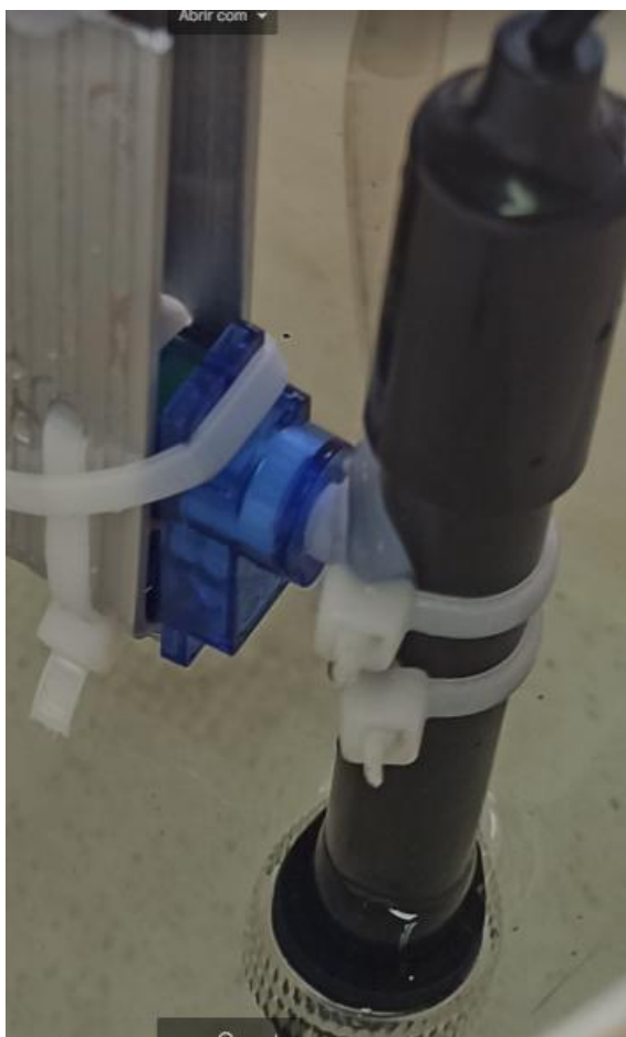
Figura 39 – Servomotor que desloca o sensor de pH para o recipiente de água.
