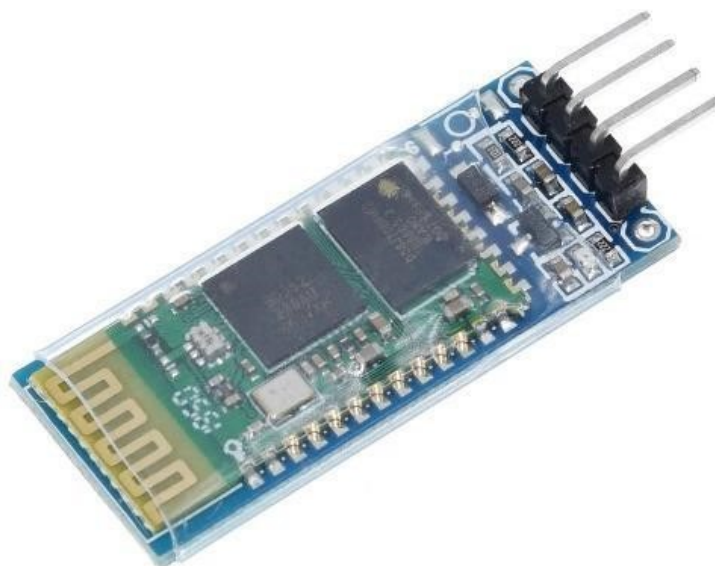
Figura 46 – Módulo Bluetooth HC-06
