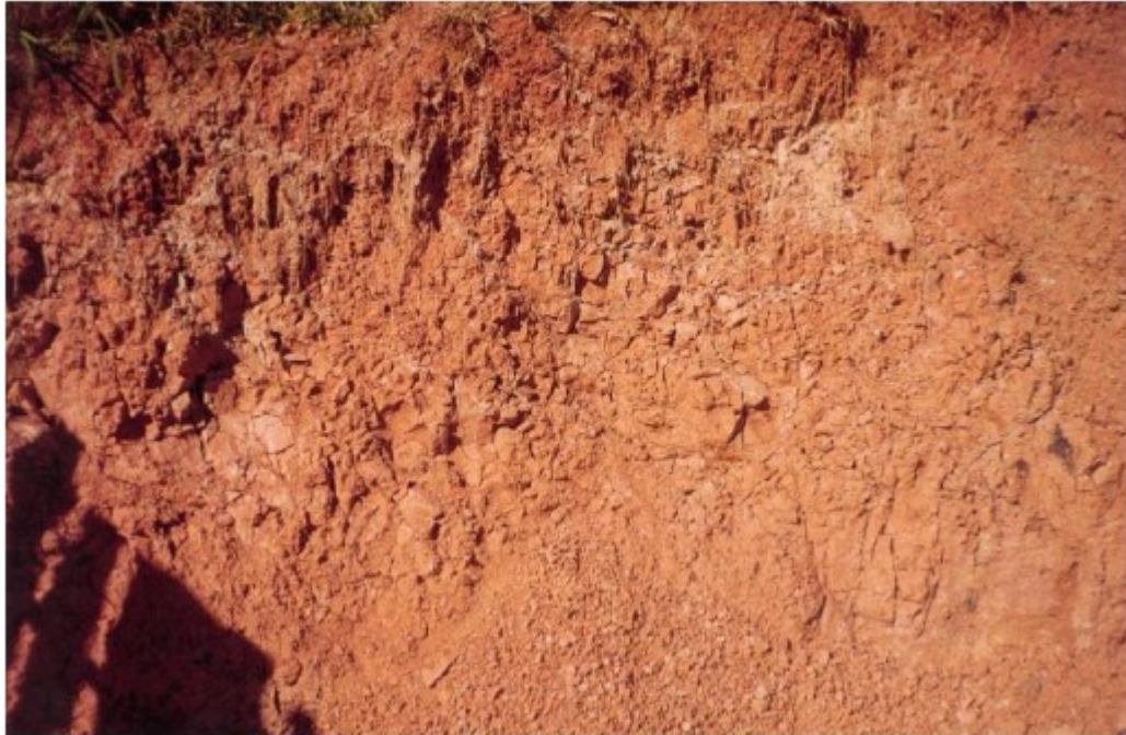
Figura 3 – Aspecto de empastilhamento pelo processo de retração em perfil da Formação Guabirotuba
