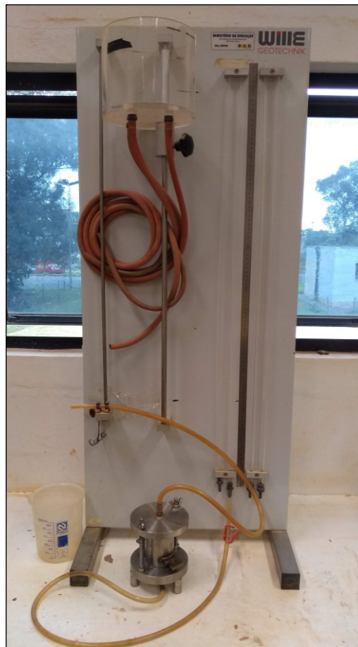
Figura 37 – Ensaio de permeabilidade à carga variável
