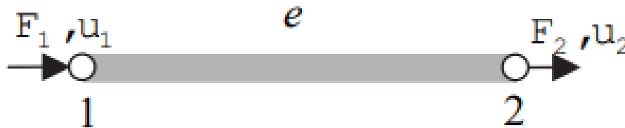
Figura 15 – Elemento de treliça com dois nós
