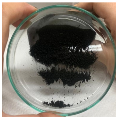
Figura 4 – Aplicação de campo magnético nas nanopartículas magnéticas de \text{Co}_3\text{O}_4
