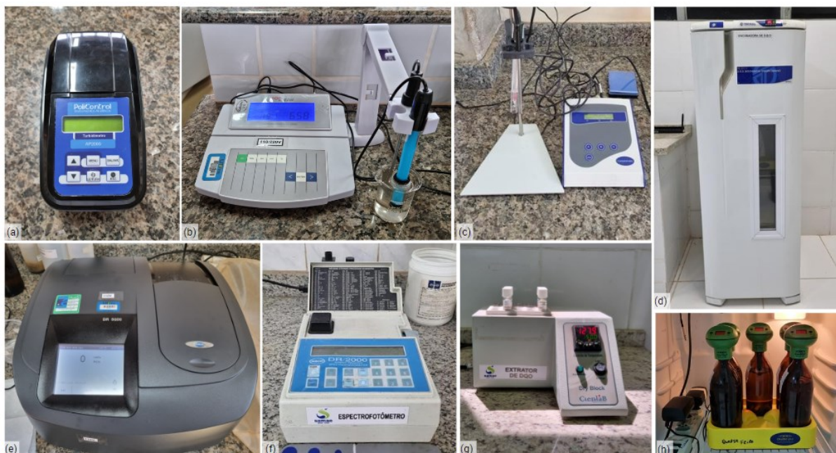
Figura 12 - Equipamentos das análises físico-químicas: (a) turbidímetro, (b) pHmetro, (c) condutivímetro, (d) incubadora BOD, (e), (f) espectrofotômetro, (g) extrator de DQO, (h) bandeja agitadora com frascos acoplados ao Oxítóp
