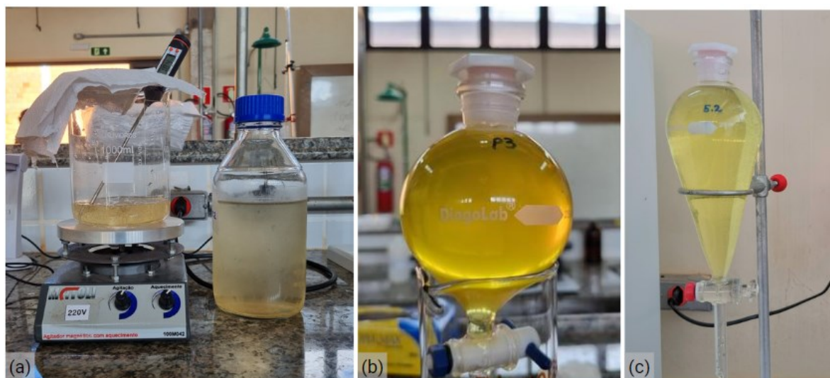
Figura 18 - Metodologia III de análise de microplásticos: (a) controle da temperatura, (b) amostra com solução Fe II, H 2 O 2 30% e NaCl, (c) amostra com solução Fe III, H 2 O 2 30% e NaCl
