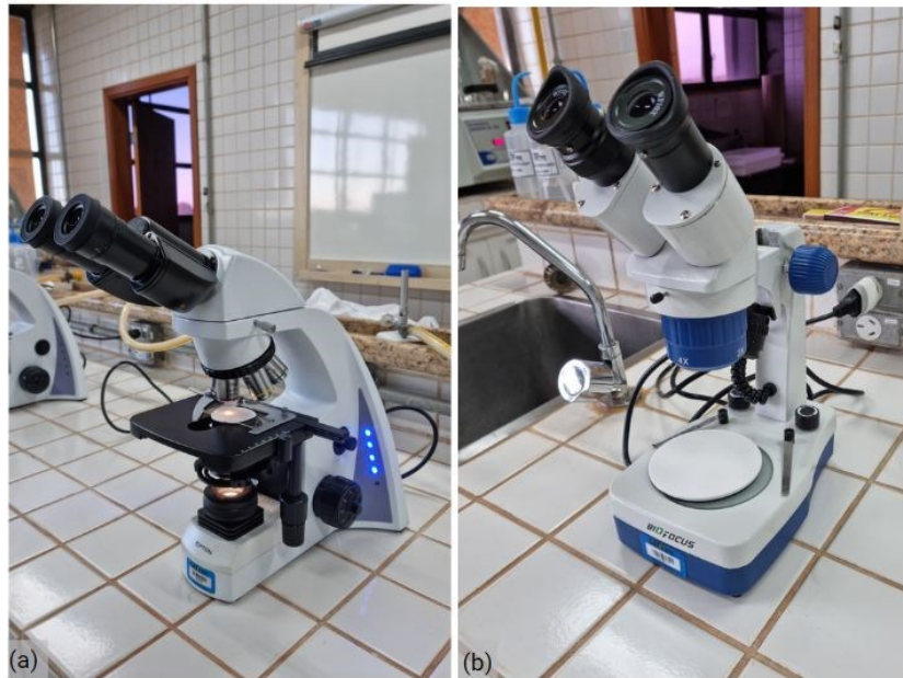
Figura 21 - Equipamentos na caracterização visual: (a) microscópio óptico, (b) estereoscópio
