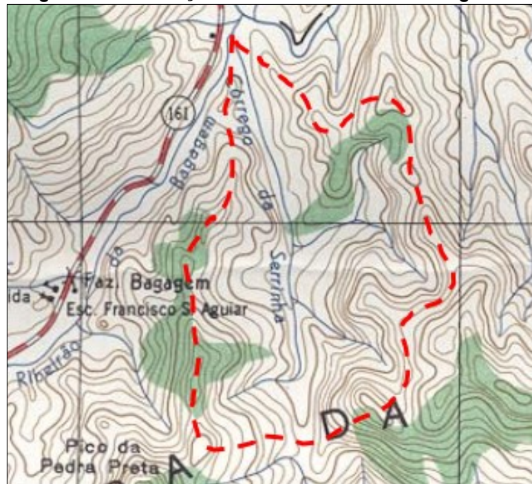
Figura 4 – Delimitação da área de uma bacia hidrográfica.
