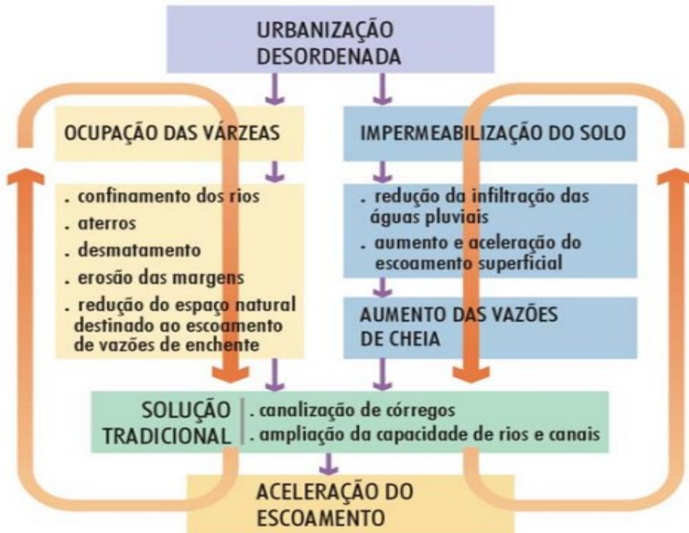
Figura 14 – Processo de impactos na drenagem urbana.
