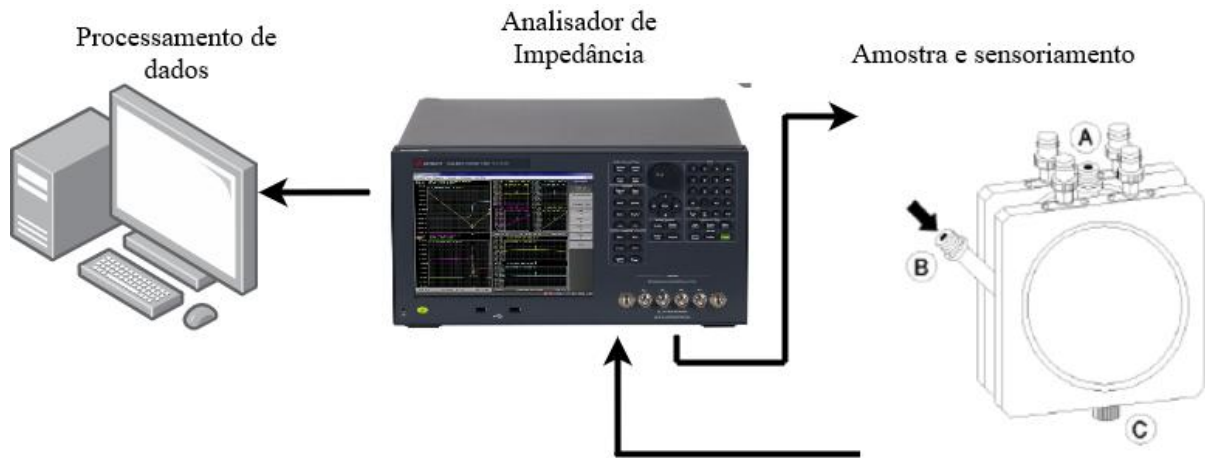
Figura 13 – Arranjo experimental comum em EIS.
