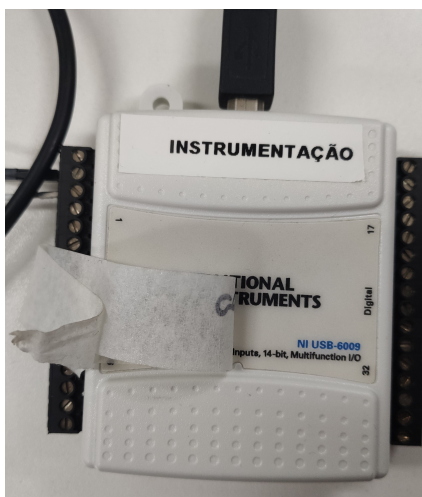
Figura 31 – Placa de aquisição de dados do sistema de medição.
