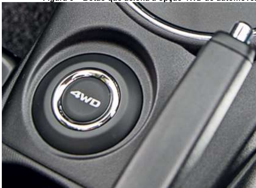
Figura 3 – Botão que aciona a opção 4WD do automóvel
