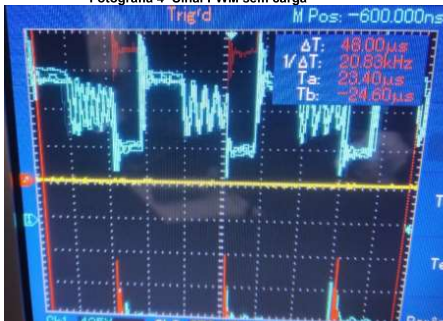
Fotografia 4- Sinal PWM sem carga
