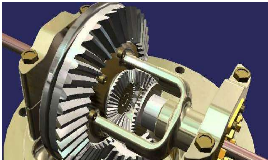
Figura 1– Engrenagens Epiciclica de um Diferencial
