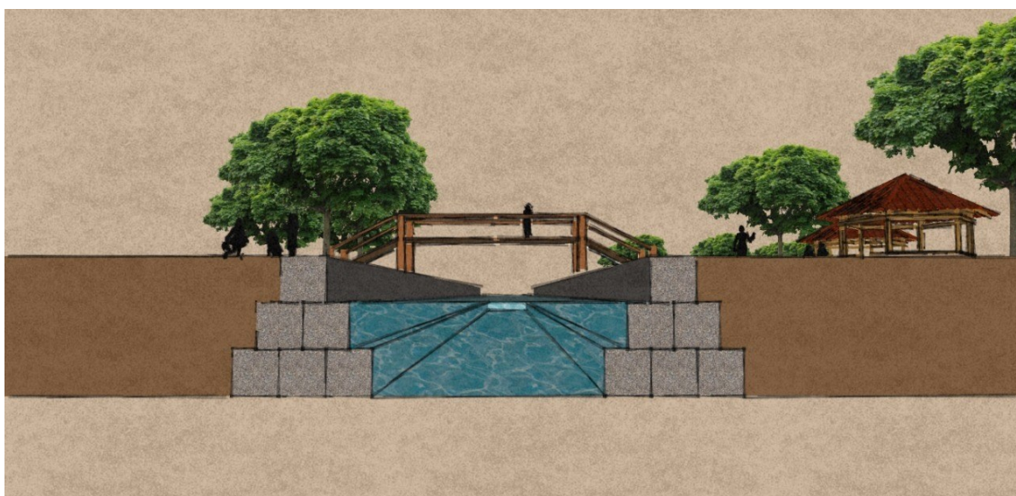
Figura 45 – Canalização com Gabiões
