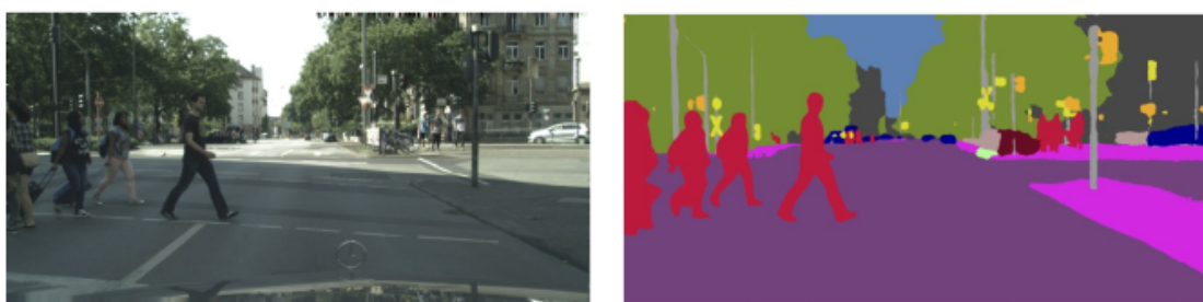
Figura 5 – Exemplo de saída esperada de um algoritmo de segmentação semântica. Cada cor representa uma classe. O vermelho, por exemplo, indica a classe “pessoa”.
