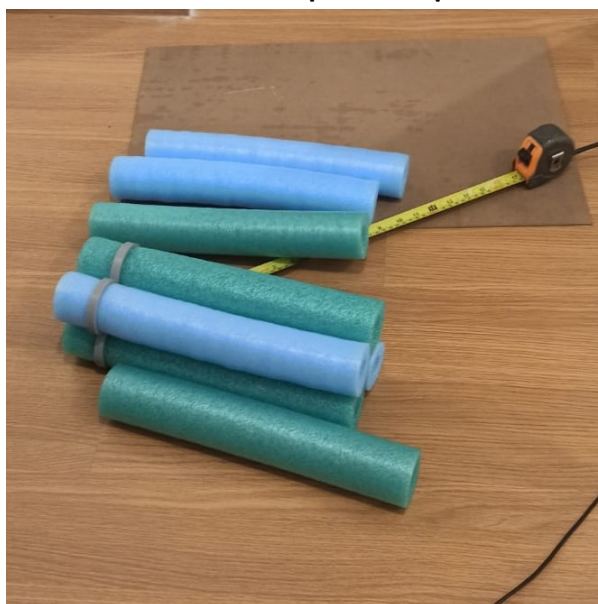
Figura 10 – Flutuadores de espuma de polietileno cortados.
