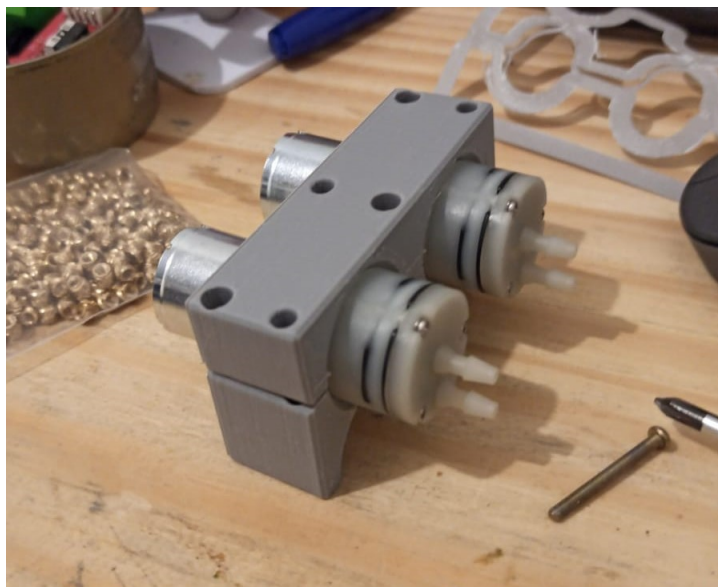
Figura 48 – Bombas montadas com a trava central e a trava superior.
