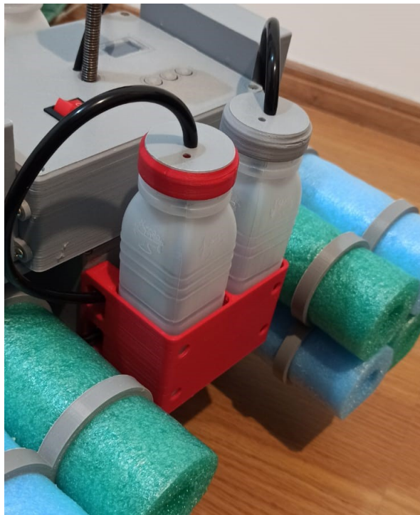
Figura 53 – Montagem do suporte das garrafas com as garrafas posicionadas.
