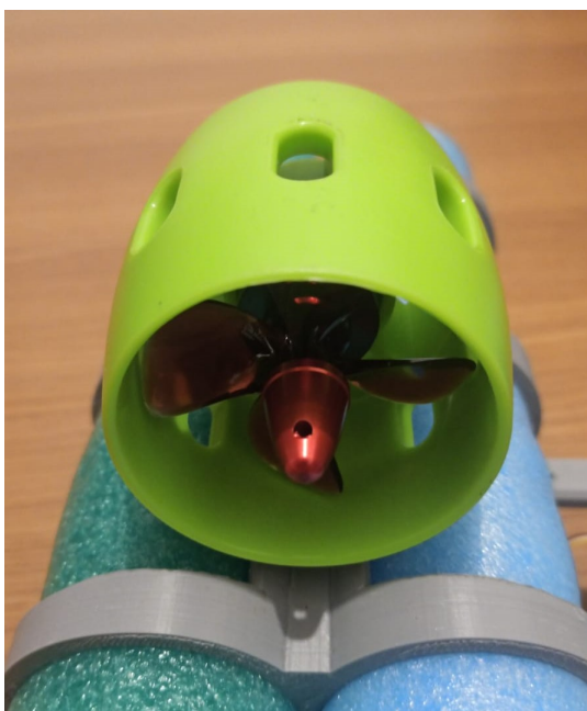
Figura 11 – Vista frontal do motor sem escova com a hélice.
