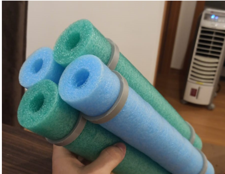
Figura 50 – Flutuadores montados nos anéis de sustentação.
