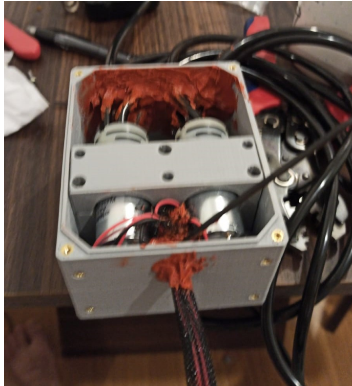
Figura 49 – Bombas montadas na caixa e seladas com silicone.
