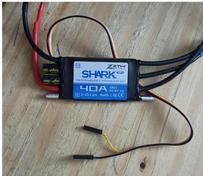
Figura 13 – Controlador eletrônico de velocidade usado no projeto.
