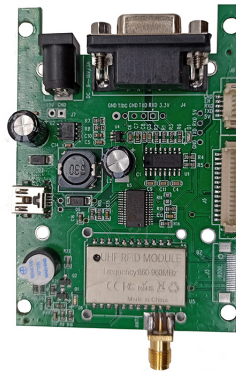
Figura 5 – Kit FM5: (a) Hardware com módulo RFID, (b) Antena que vai conectada ao módulo (a) Hardware Leitor RFID (b) Antena
