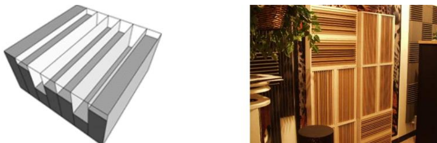
Figura 4 – Ilustração esquemática de um difusor acústico e sua aplicação, [30].
