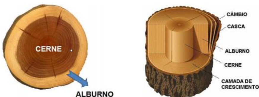
Figura 3 – Distinção entre cerne e alburno (esq.), [17]. Componentes de uma secção de tronco (dir.), [17]
