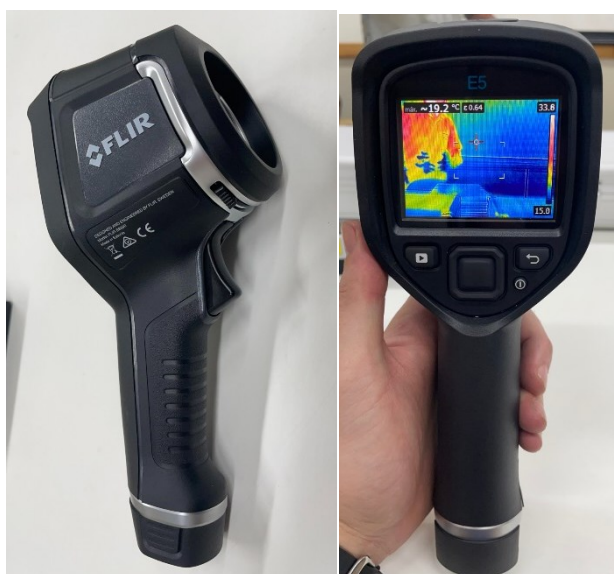
Figura 15 – Câmera termográfica FLIR EX Series para mensuração da temperatura do processo de torneamento
