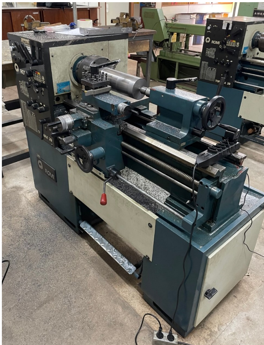
Figura 13 – Torno utilizado para o processo de usinagem (torneamento) da peça FC-300
