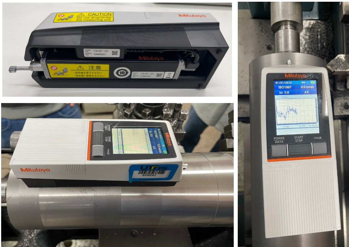
Figura 16 – Rugosímetro Mitutoyo SJ-210 para análise da qualidade do acabamento da peça torneada
