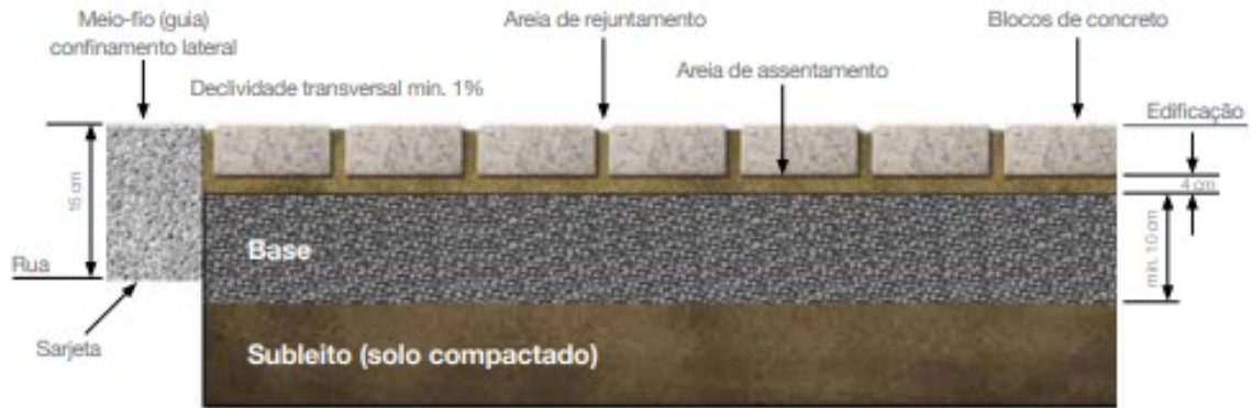
Figura 3: Estrutura típica dos pavimentos intertravados de concreto
