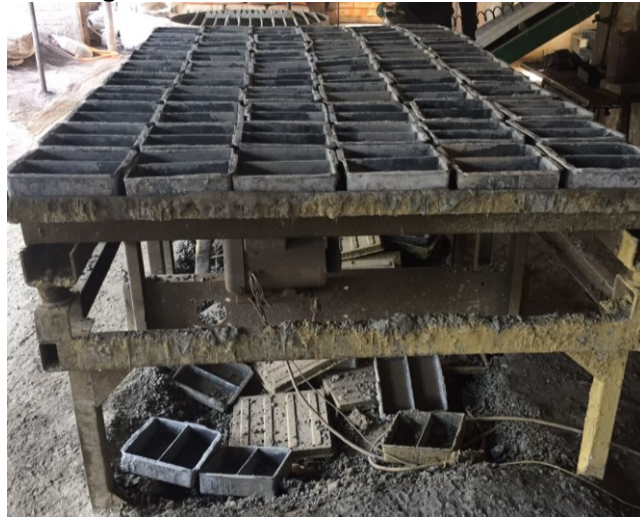
Figura 8: Formas sobre mesa vibratória
