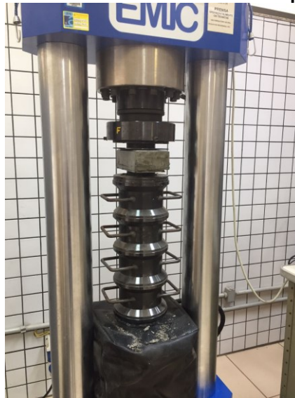
Figura 10: Ensaio de resistência à compressão
