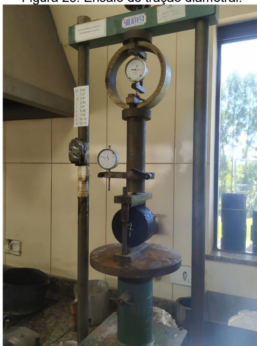
Figura 26: Ensaio de tração diametral.
