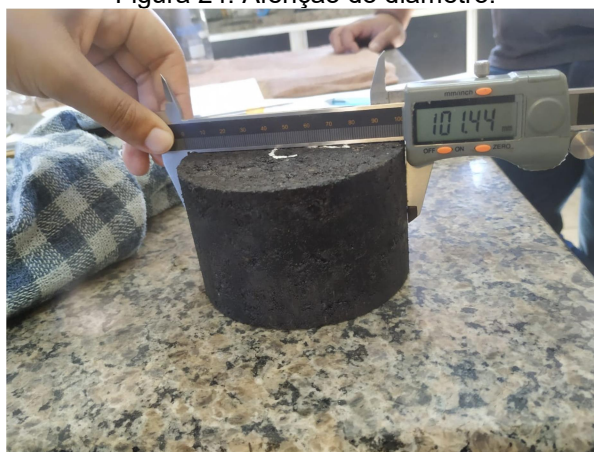
Figura 24: Aferição do diâmetro.
