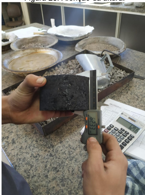
Figura 23: Aferição da altura.
