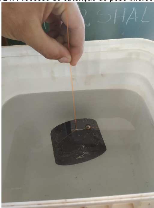
Figura 21: Processo de obtenção do peso imerso do CP.
