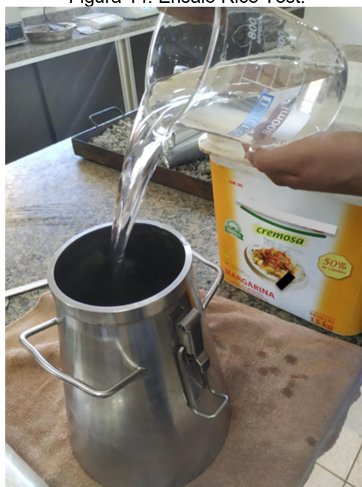
Figura 14: Ensaio Rice Test.
