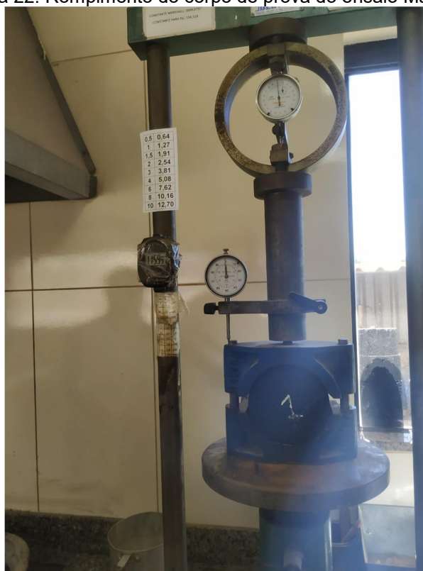
Figura 22: Rompimento do corpo de prova do ensaio Marshall.
