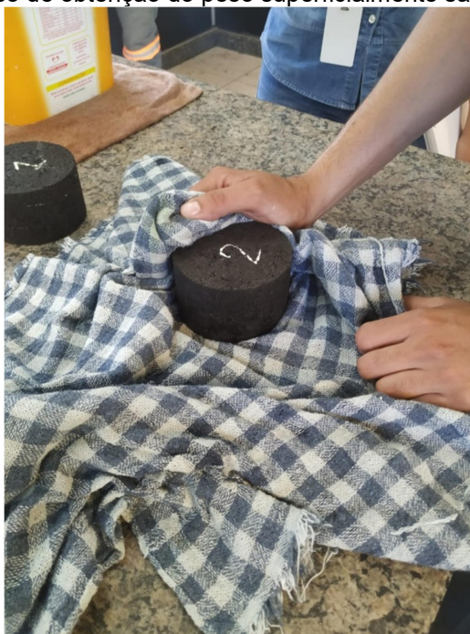
Figura 19: Processo de obtenção do peso superficialmente saturado seco do CP.
