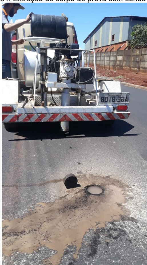
Figura 34: Extração do corpo de prova com sonda rotativa.
