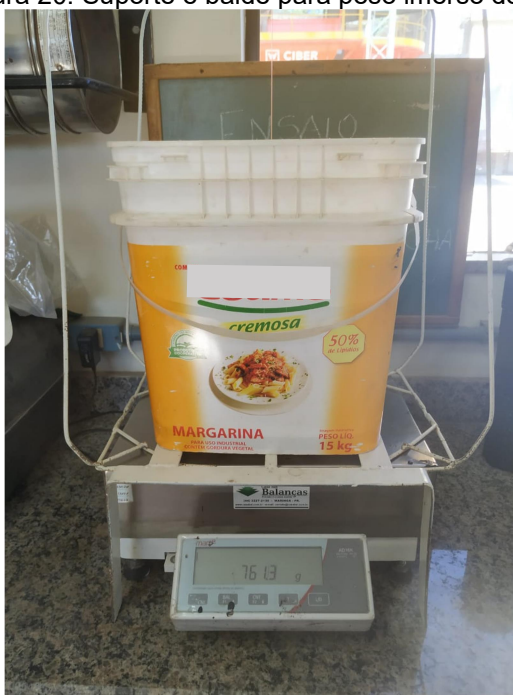
Figura 20: Suporte e balde para peso imerso do CP.
