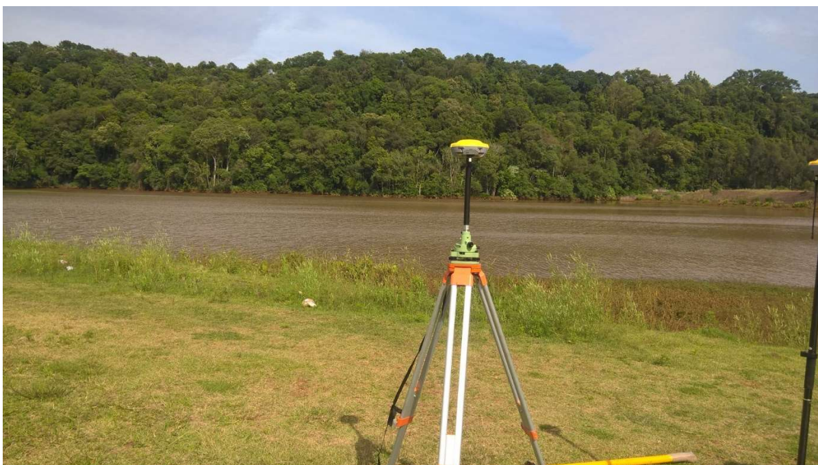
Figura 15 – Base do GPS RTK 500.
