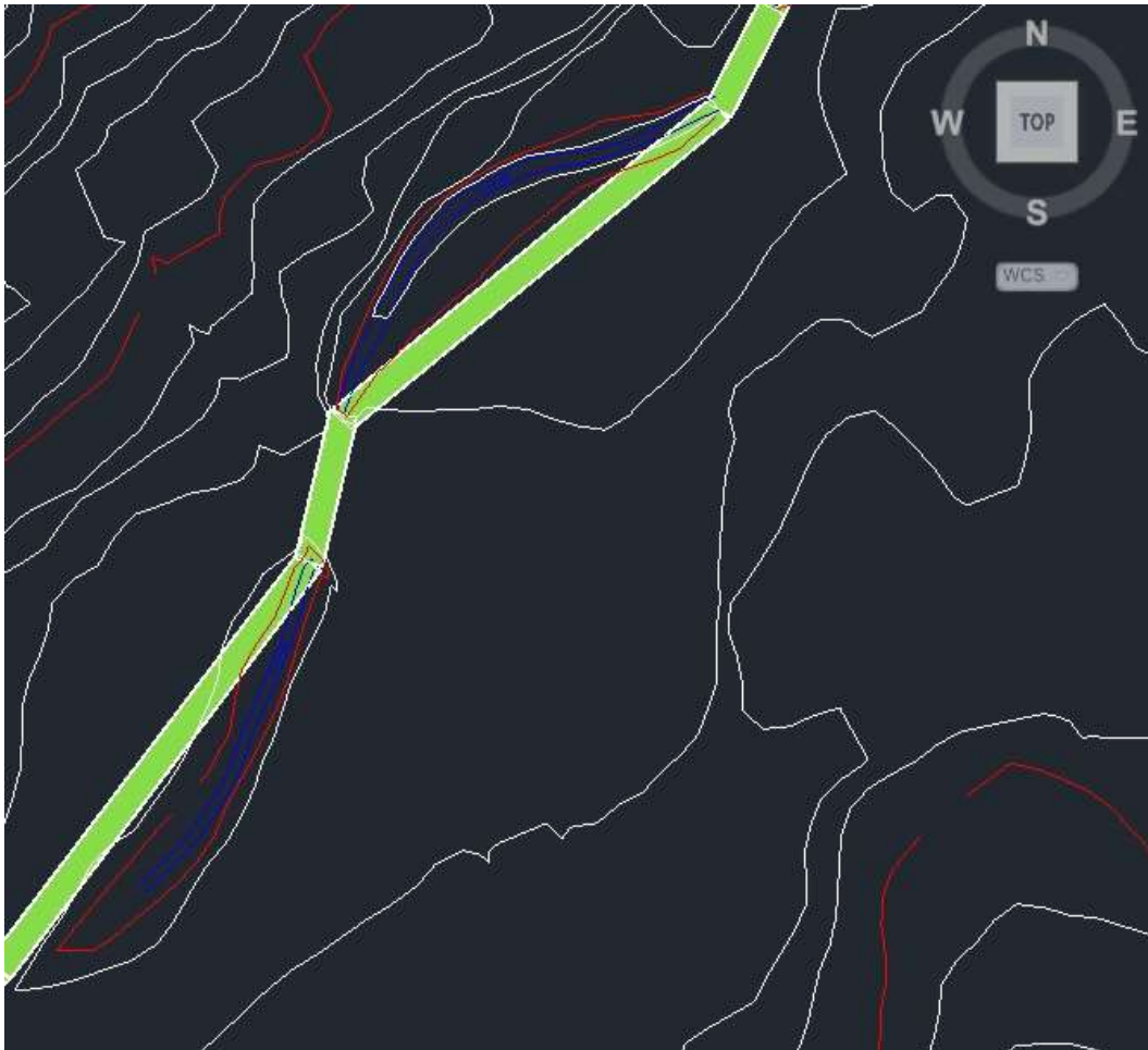
Figura 14 – Trecho canalizado do Córrego Fundo em comparação com a topografia desatualizada.
