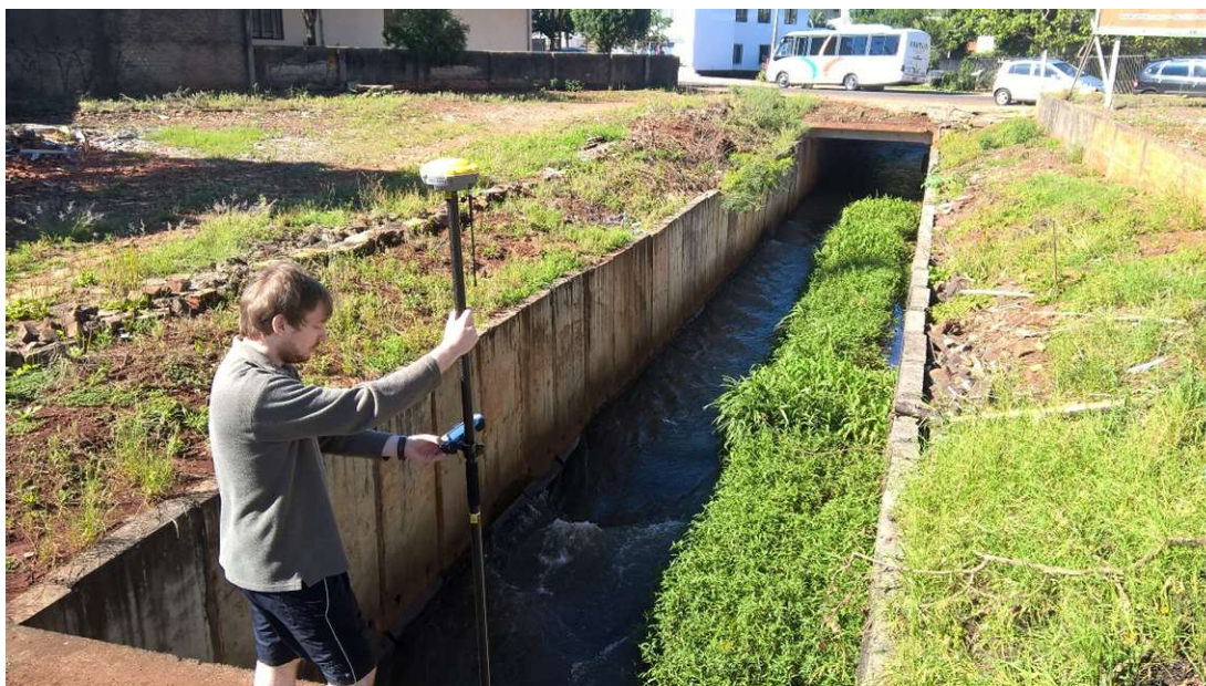
Figura 16 – Retificação da topografia com auxílio de GPS.
