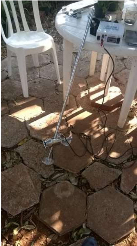
Figura 26 – Molinete utilizado na medição.
