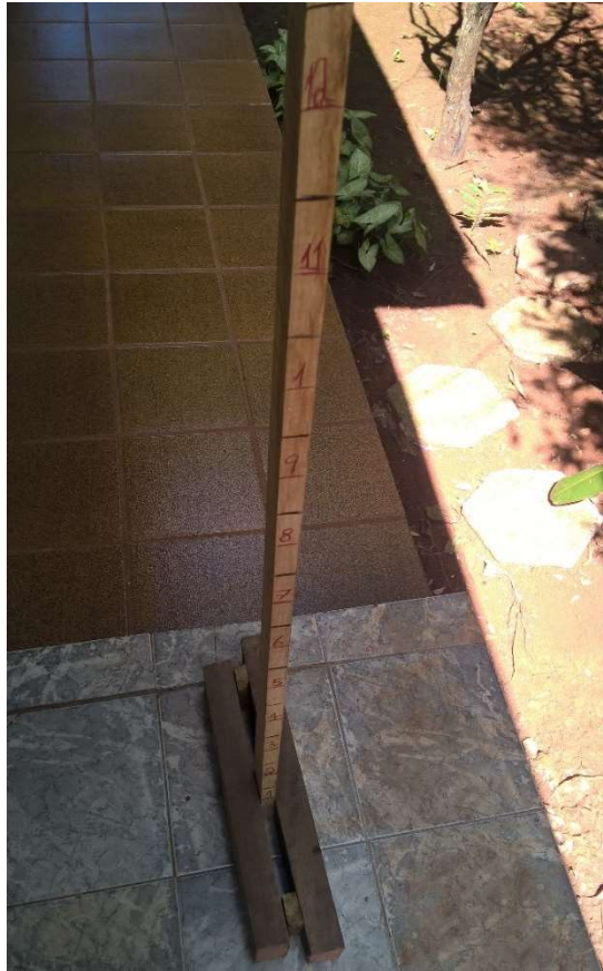
Figura 45 – Régua artesanal utilizada nas etapas de calibração e validação do modelo hidrológico.
