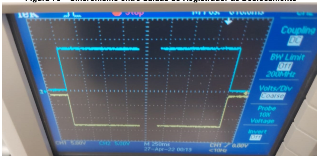
Figura 75 – Sincronismo entre Saídas do Registrador de Deslocamento
