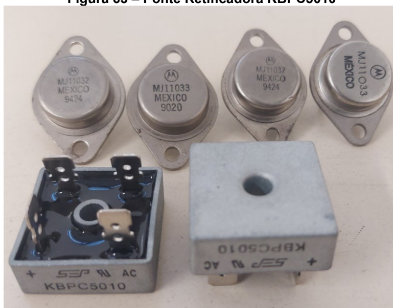
Figura 63 – Ponte Retificadora KBPC5010
