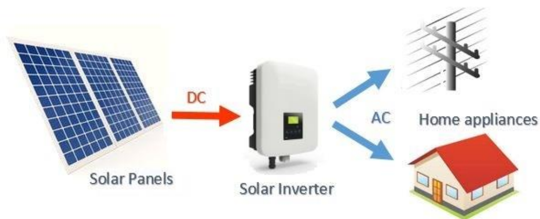
Figura 4 – Layout simplificado de um sistema de energia solar comum conectado à rede (on-grid).
