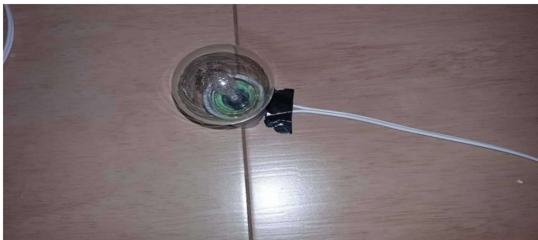
Figura 17: soquete preso a superfície por fita isolante.
