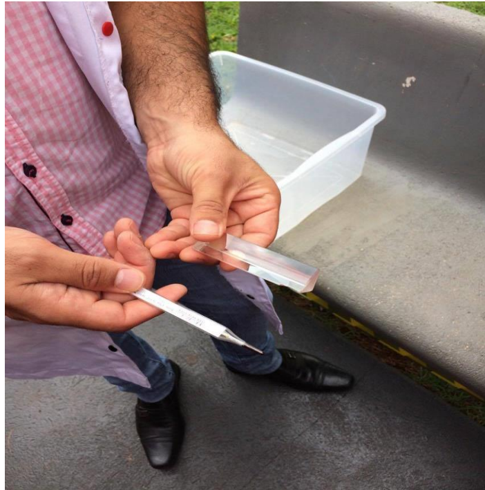
Figura10: Termômetro de mercúrio com a ponta pintada de preto e prisma de vidro.
