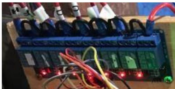
**Figura 28 – Conjunto de 8 relés eletromecânicos 12V.**
