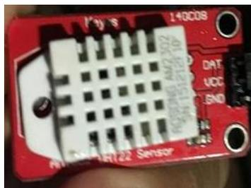
**Figura 11 – Sensor DHT22.**
