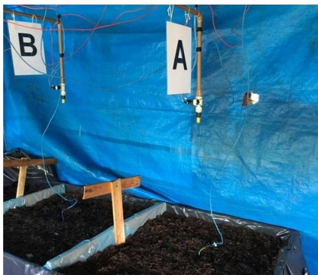
**Figura 52 – Sensor no substrato, enviando informação para o Arduino e acionando a válvula quando necessário.**
