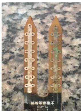
**Figura 40 – Sensor de umidade de solo YL-69.**
