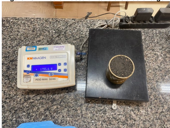
Figura 15 - Ensaio massa unitária areia de britagem
