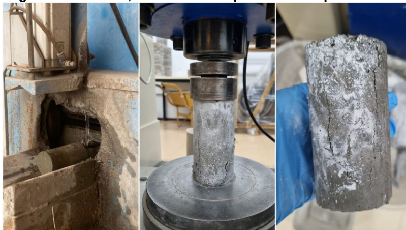
Figura 17 - Retifica, Ensaio de Compressão e Corpos de Prova
