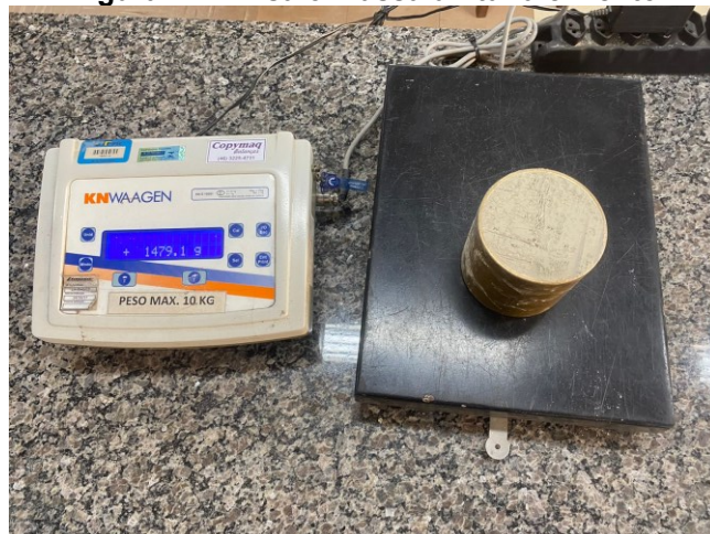
Figura 12 - Ensaio massa unitária cimento
