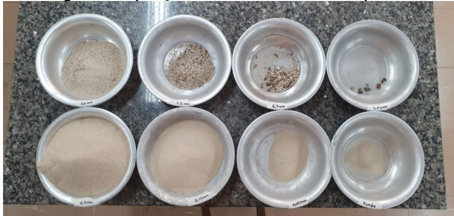
Figura 7 – Separação do material retido em cada peneira
