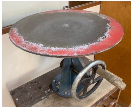
Figura 18 - Mesa de Consistência "Flow Table"
