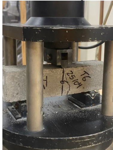
Figura 30 - Ensaio de tração na flexão
