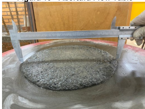
Figura 19 - Abertura Flow Table
