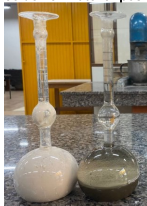
Figura 9 - Frasco de Le Chatelier pós segunda leitura
