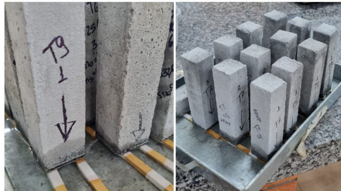
Figura 40 - Ensaio de absorção de água por capilaridade
