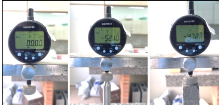
Figura 26 - Uso equipamento de comparação de comprimento.
