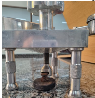
Figura 37 – Incompatibilidade de encaixe no segundo equipamento.
