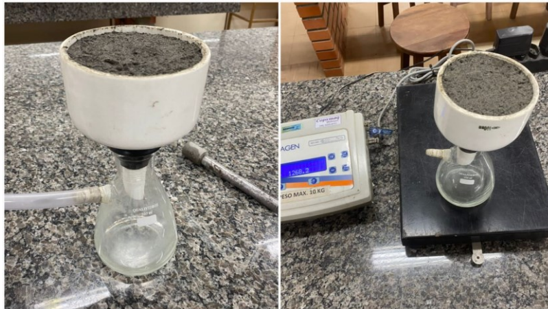
Figura 22 - Massa conjunto funil argamassa após sucção ( m_s )
