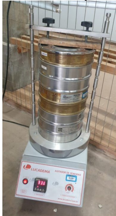
Figura 6 - Agitador mecânico e Conjunto de Peneiras
