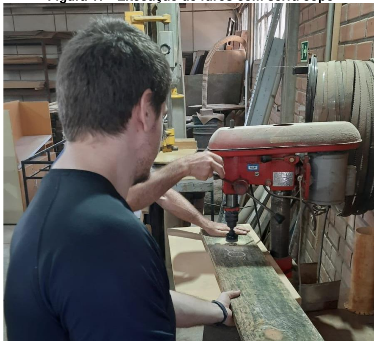
Figura 17 - Execução de furos com serra copo
