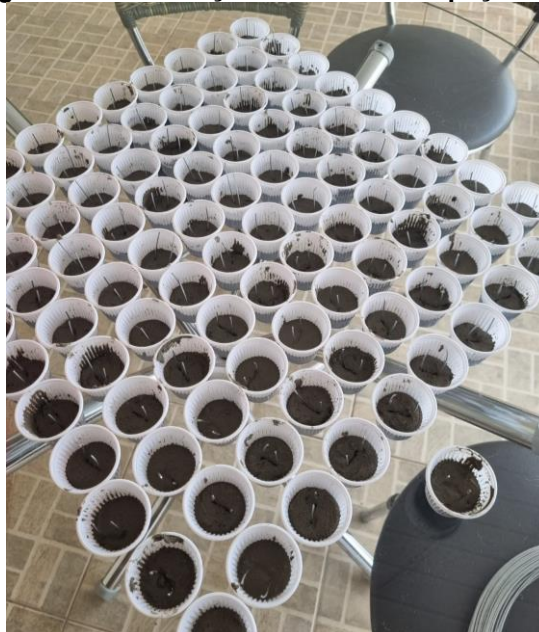
Figura 20 - Fabricação caseira dos espaçadores
