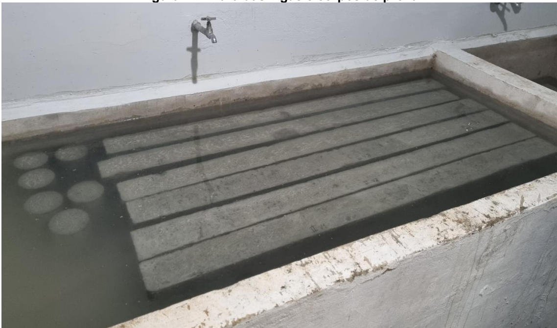
Figura 24 - Cura das vigas e corpos de prova
