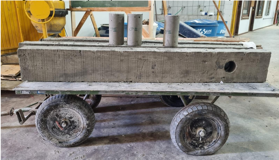
Figura 23 – Vigas e corpos de prova desformados a caminho do tanque de cura
