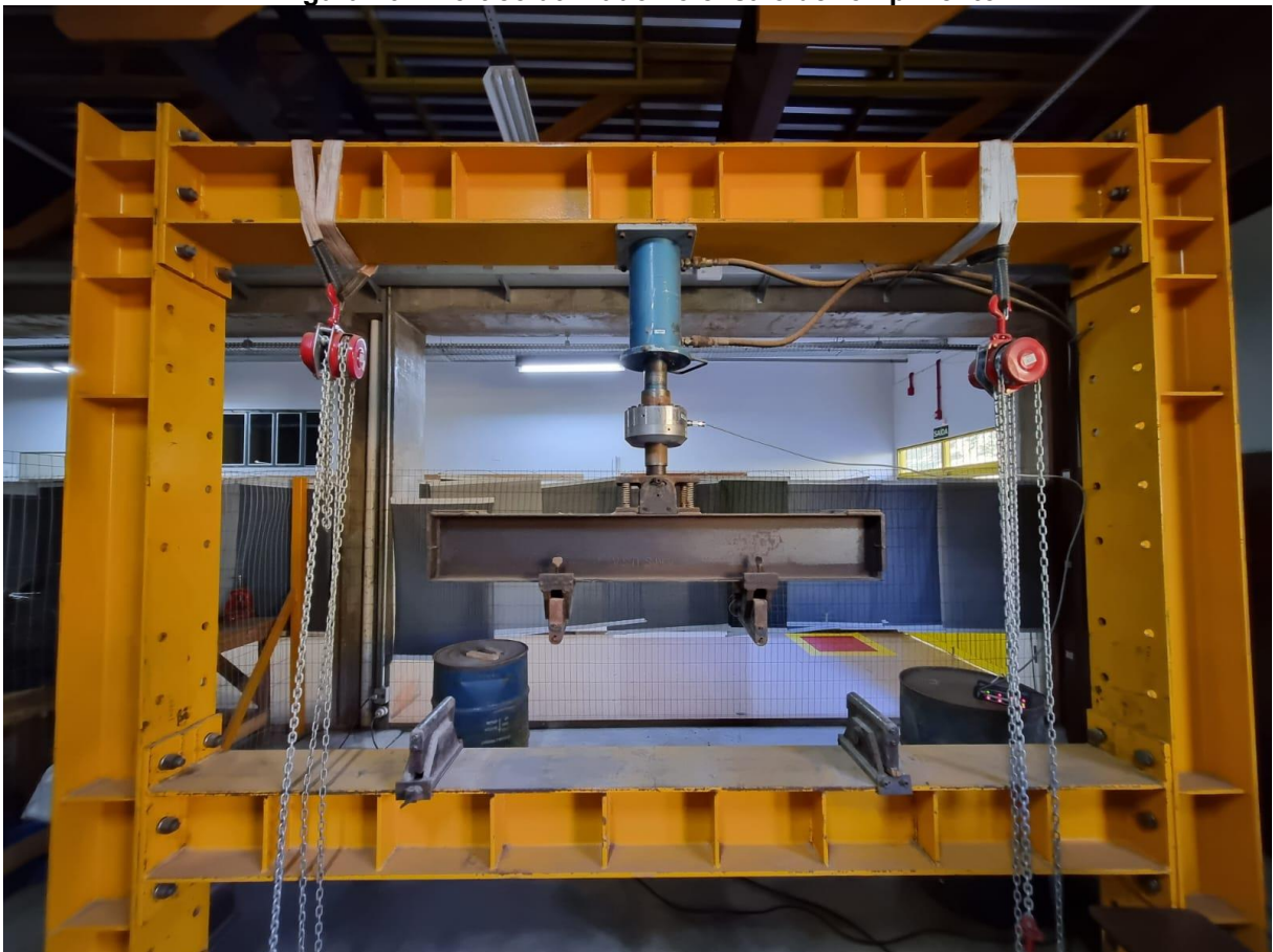
Figura 26 – Pórtico utilizado no ensaio de rompimento
