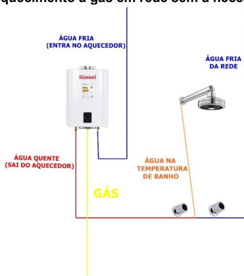
Figura 6: Sistema de aquecimento a gás em rede sem a necessidade de pressurização.
