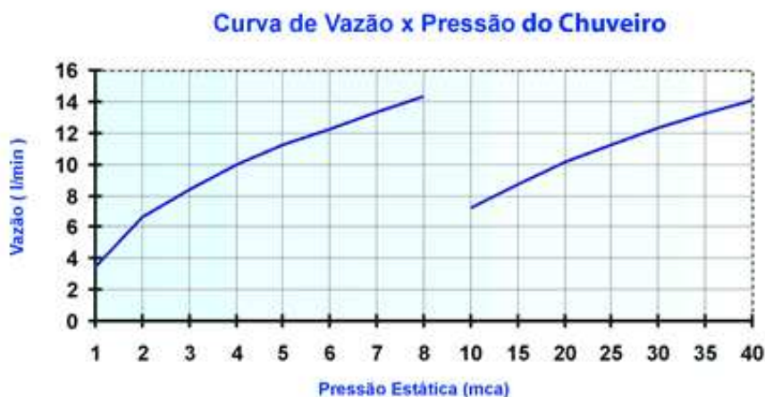
Figura 3: Curva de vazão x pressão do chuveiro
