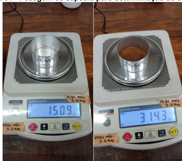
Figura 61 - Pesagem de cápsula para determinação de umidade
