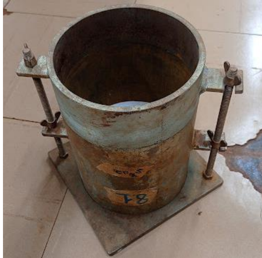
Figura 64 - Conjunto de base, molde cilíndrico e colarinho
