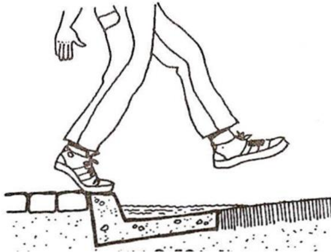
Figura 29 - Largura da sarjeta, em relação a passo de uma pessoa
