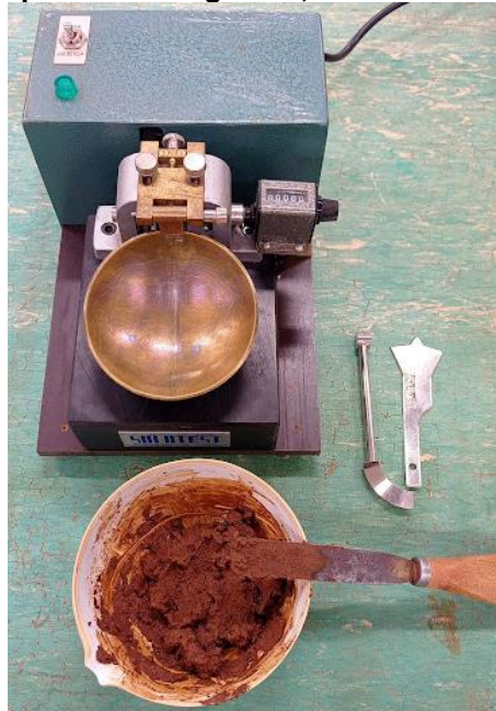
Figura 63 - Aparelho Casagrande, amostra de solo e cinzéis
