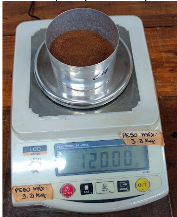
Figura 57 - Amostra separada para ensaio de peneiramento fino
