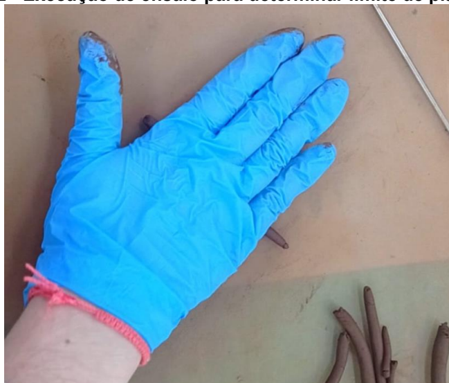
Figura 62 - Execução de ensaio para determinar limite de plasticidade
