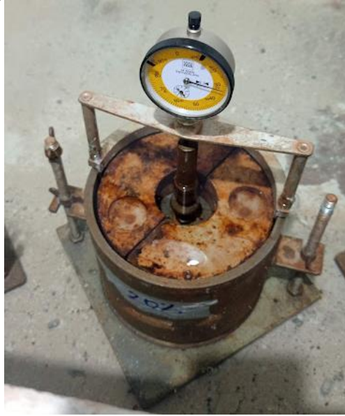
Figura 65 - Conjunto de corpo de prova, disco anelares e extensômetro
