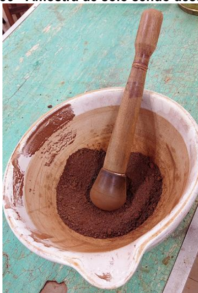
Figura 56 - Amostra de solo sendo destorroada
