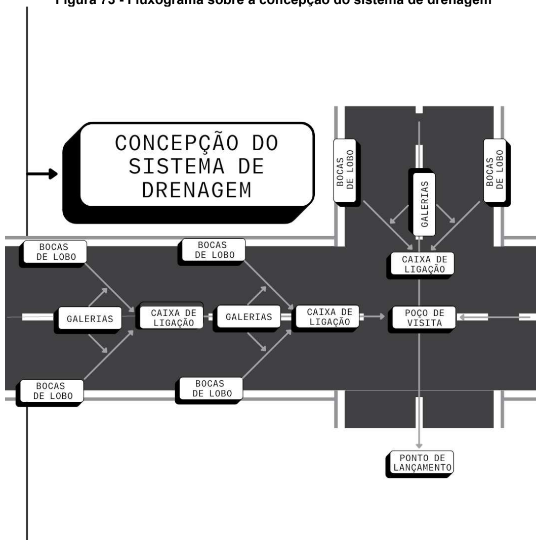
Figura 73 - Fluxograma sobre a concepção do sistema de drenagem
