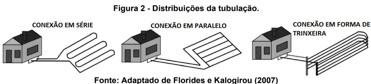
A respeito das configurações de projetos do trocador de calor solo-ar, Mavroyanopoulos e Kyritsis (1983) construíram um trocador de calor com 20 tubos de alumínio de 15 m de comprimento e 20 cm de diâmetro, enterrados a 2 m de profundidade embaixo de uma estufa, na Grécia. O fluxo de ar foi mantido por um ventilador e a média de temperatura no interior da estufa ficou em 8 °C, enquanto a temperatura média do ar externo à estufa era de -0,8 °C.
