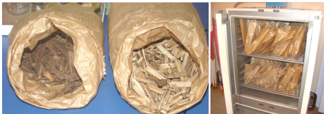
Figura 12 - Procedimento de preparação das amostras de biomassa e quantificação do teor de carbono casca (à esquerda) e galhos (à direita) para secagem em estufa de circulação de ar
