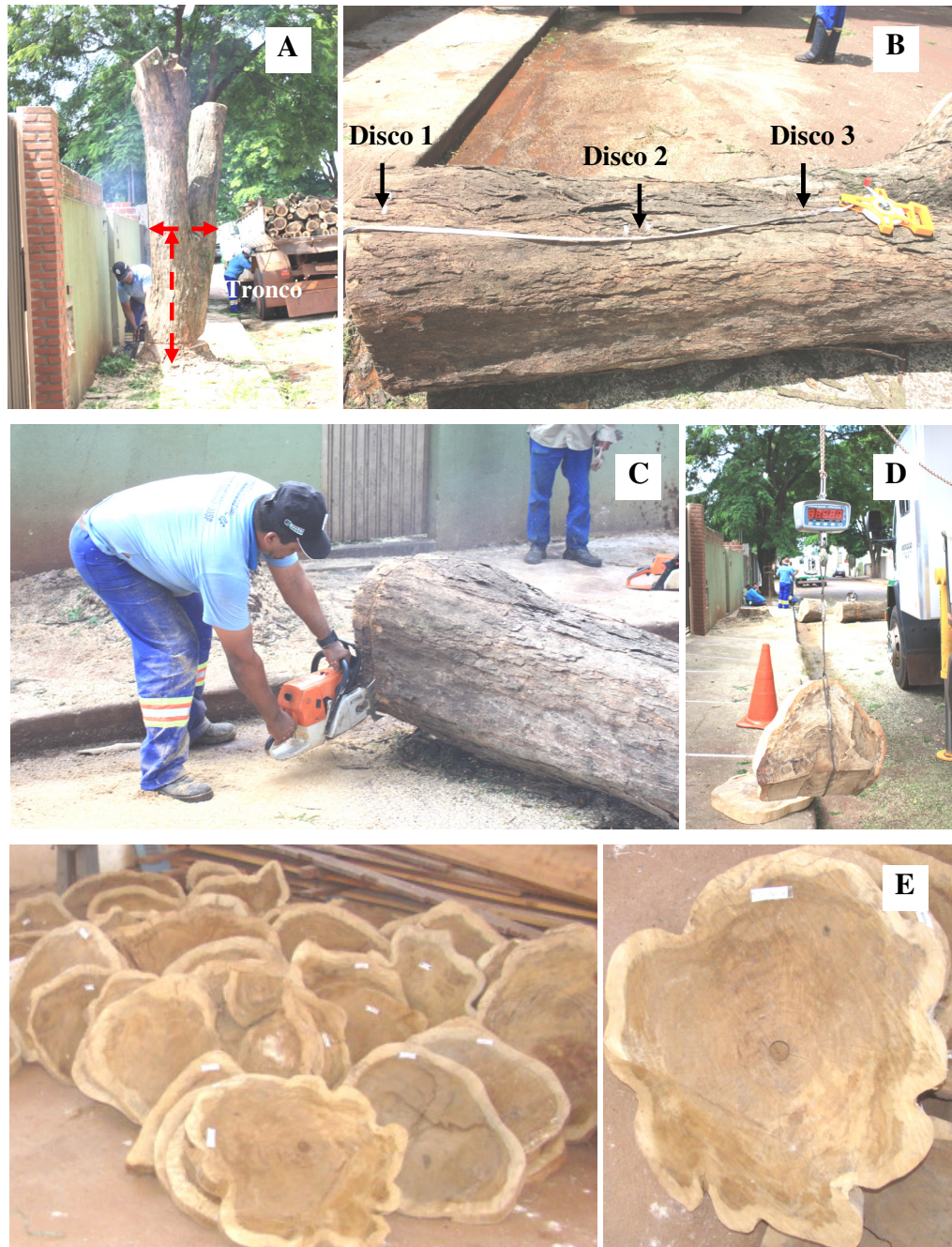
Figura 11 - Procedimento de corte e amostragem da madeira do tronco: A) Procedimento de corte do tronco; B) Demarcação dos locais de retirada dos discos amostrais; C) Retirada do disco de madeira na posição da base do tronco; D) Pesagem dos discos em balança de gancho das árvores amostra abatidas no Bairro Cidade Alta, Maringá – PR; E) Acondicionamento dos discos de amostragem da fração madeira (2010)
