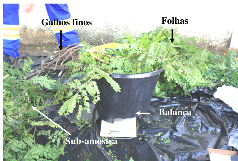
Figura 9 - Sub-amostragem de folhas e galhos finos para o estabelecimento da proporcionalidade das frações na copa das árvores abatidas
