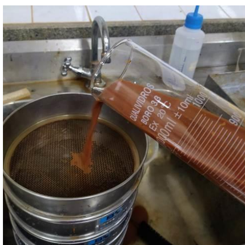
Figura 7 - Peneiras 1,2 mm, 0,6 mm, 0,42 mm, 0,25 mm, 0,15 mm, 0,075mm para ensaio de peneiramento
