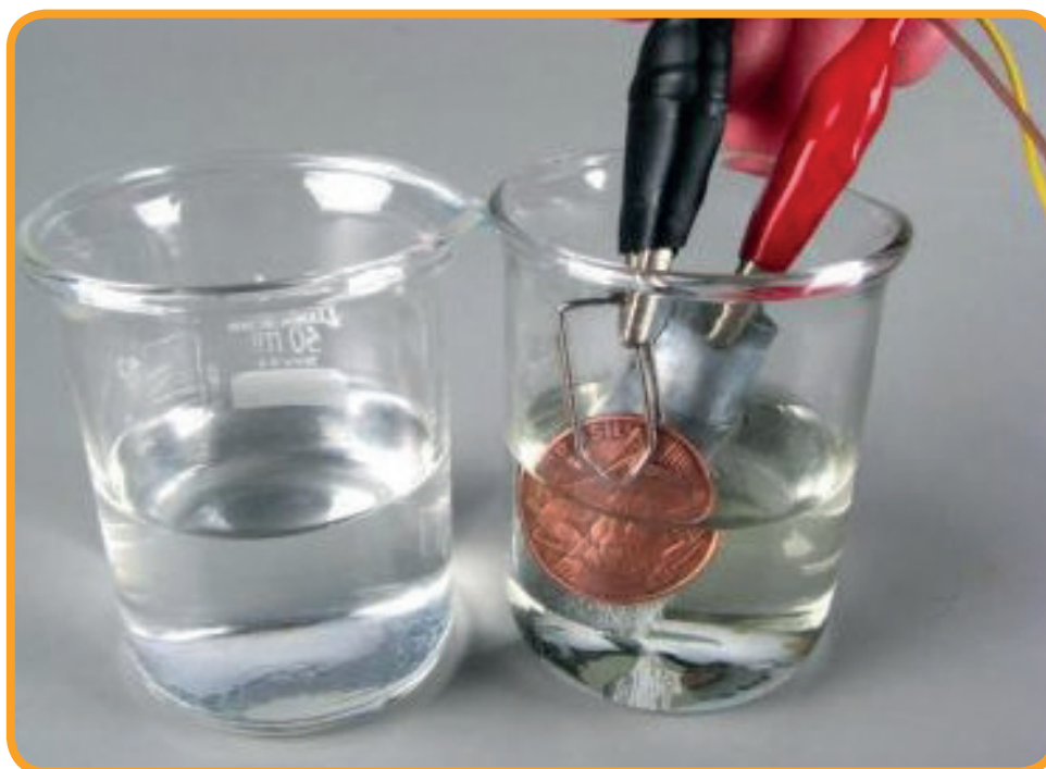
Figura 5 – Eletrólise com uma moeda de 5 centavos
