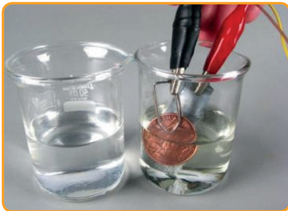
Figura 9 – Eletrólise com uma moeda de 5 centavos
