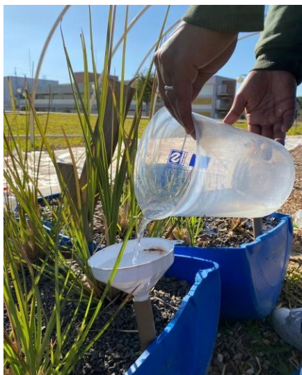
Figura 5 – Carregamento das wetlands construídas
