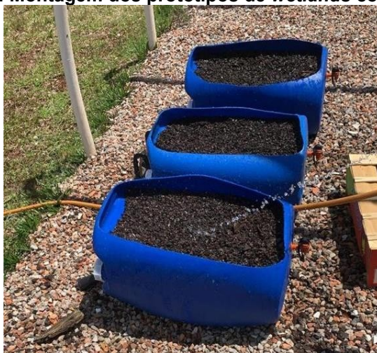
Figura 1: Montagem dos protótipos de wetlands construídas
