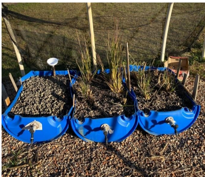
Figura 2 – Protótipos de wetlands construídas
