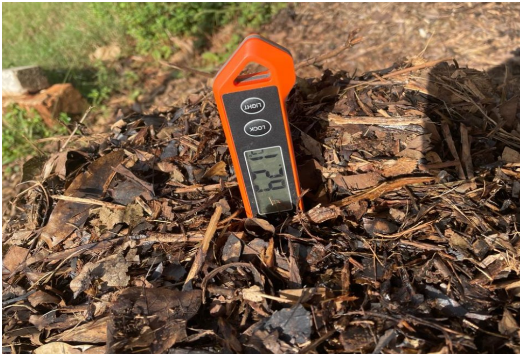
Figura 5 – Aferição da temperatura no topo da pilha de compostagem
