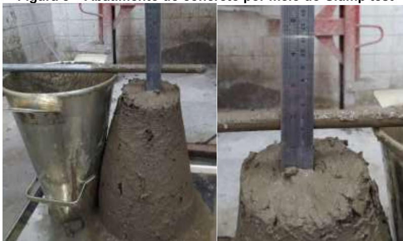
Figura 8 – Abatimento do concreto por meio do Slump test
