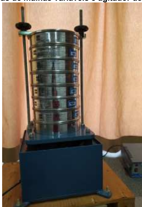
Figura 1 - Peneiras de malhas variáveis e agitador de peneira.
