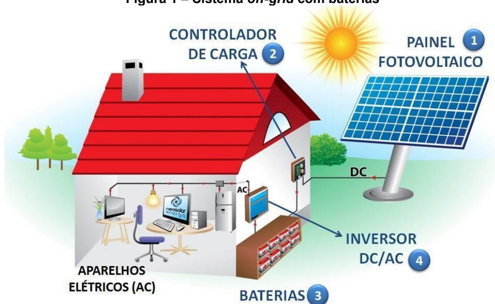
Figura 1 – Sistema off-grid com baterias
