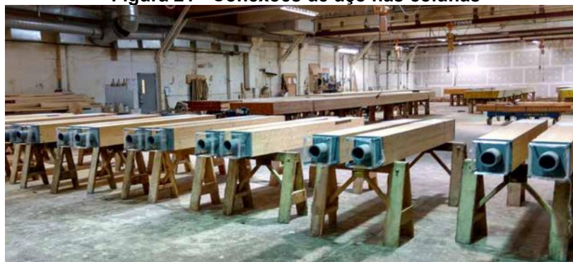
Figura 21 - Conexões de aço nas colunas
