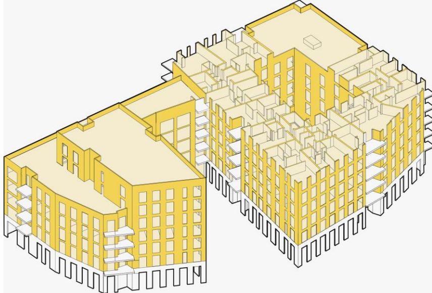
Figura 31 - Estrutura em MLCC em Dalston Lane
