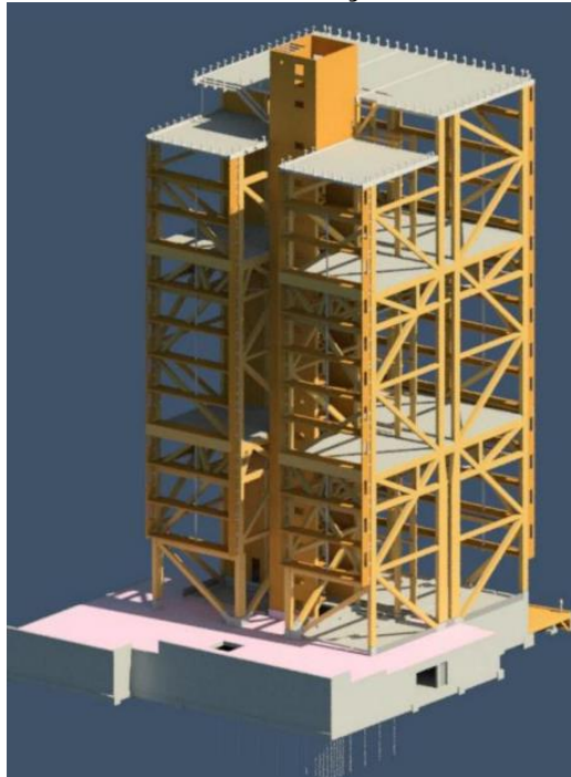
Figura 24 - Módulos de construção do edifício The Tree
