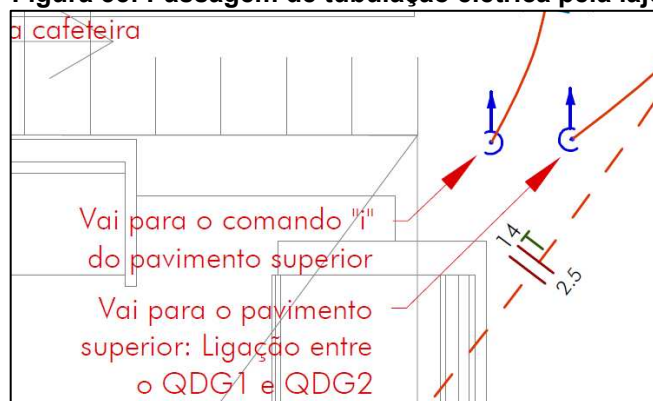
Figura 55: Passagem de tubulação elétrica pela laje
