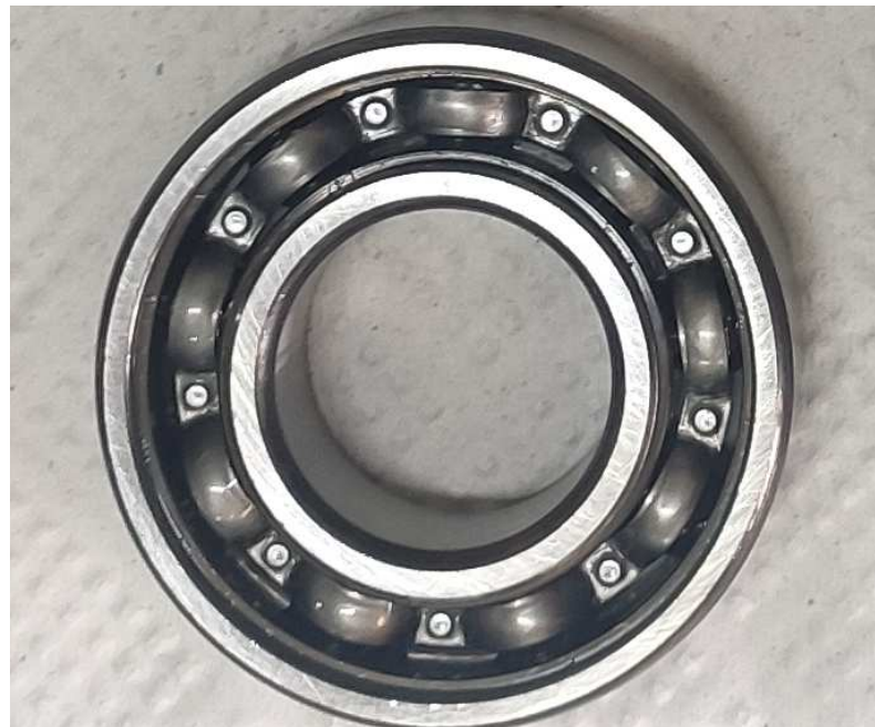
Figura 36 – Rolamento sem lubrificação.
