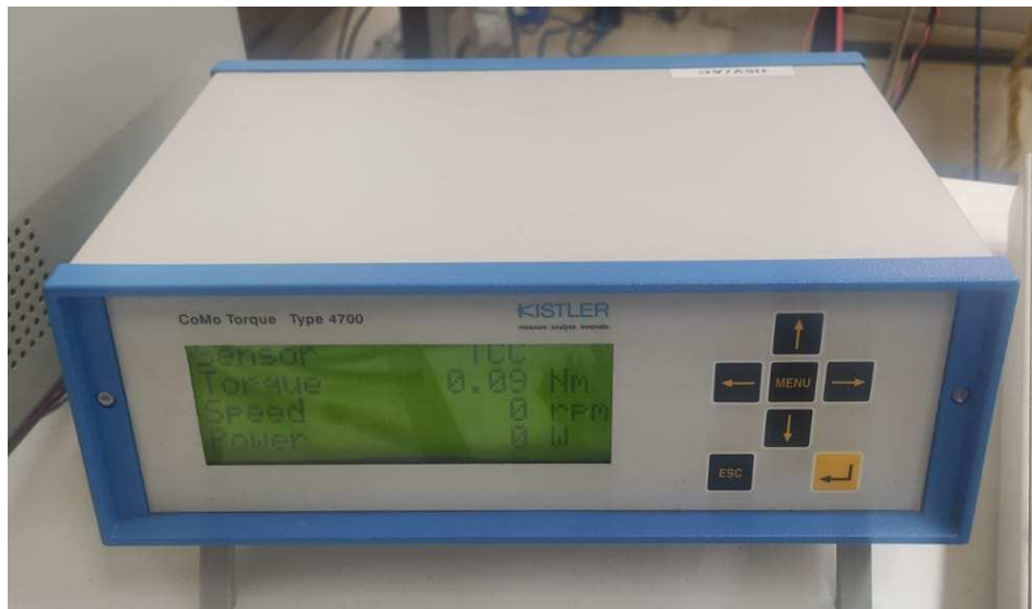
Figura 29 – Sistema de condicionamento de sinais para o torquímetro.
