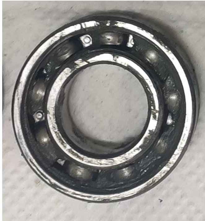
Figura 37 – Rolamento com pasta abrasiva.
