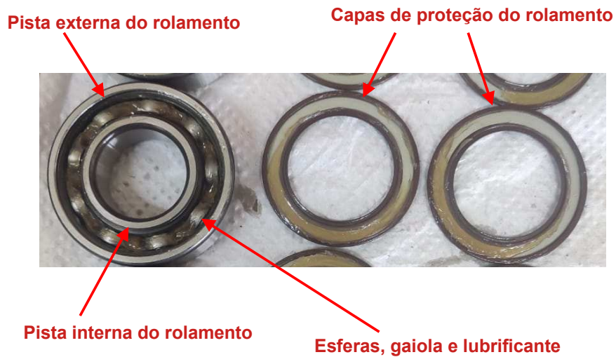
Figura 35 – Rolamento sem a capa de proteção.
