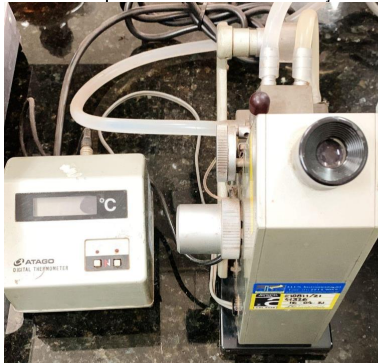
Figura 4 - Refratômetro utilizado para as medidas de índice de refração das amostras de café.
