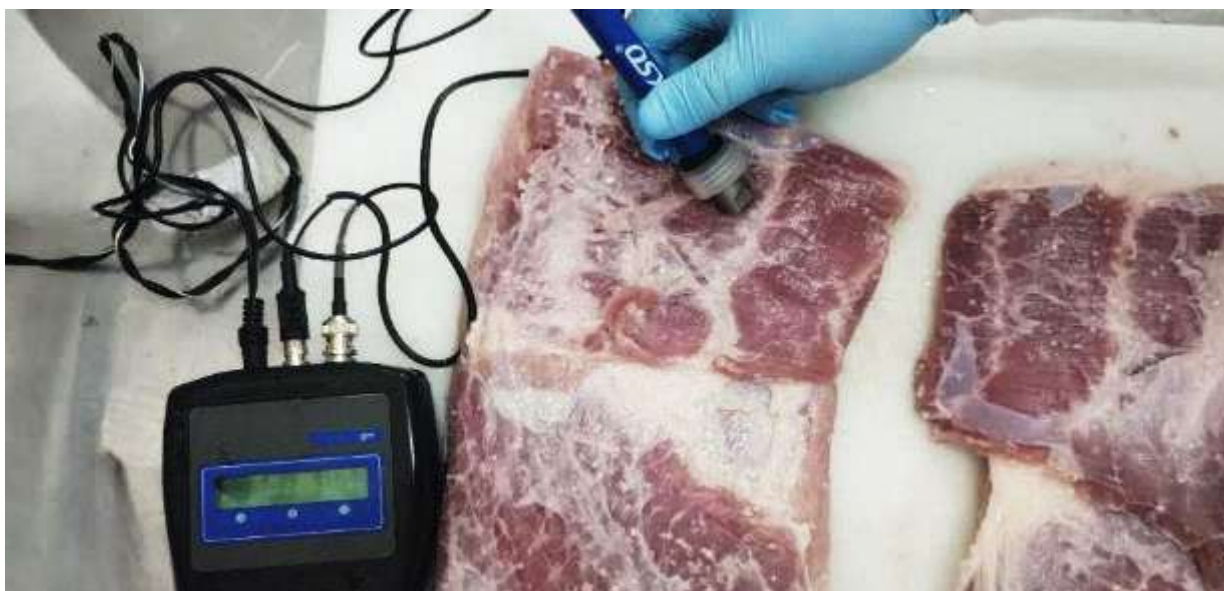
Figura 5: Análise do pH utilizando um pHmetro de mesa
