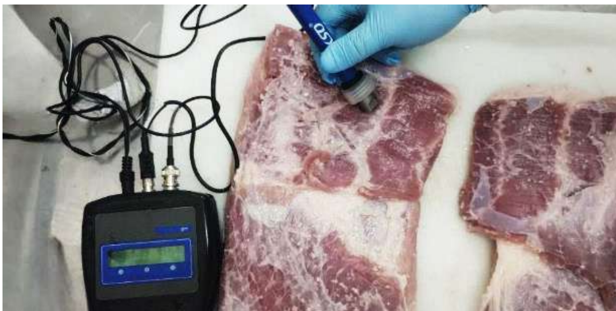
Figura 6: Análise do pH utilizando um pHmetro portátil
