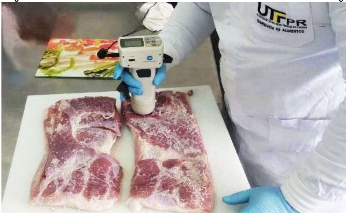
Figura 6 : Índice de cor com o auxílio de um Colorímetro CR-400 da Konica Minolta Sensing
