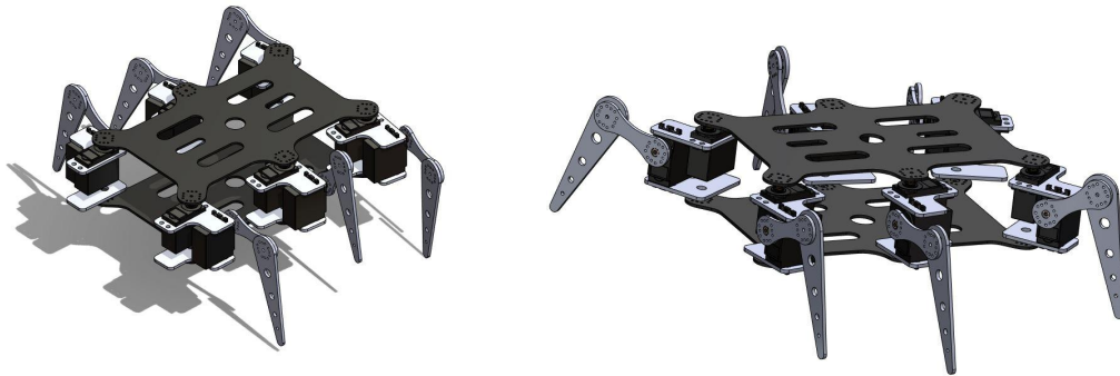
Figura 10 – Estrutura do hexapóde elaborada no SolidWorks: (a) Vista superior, (b) Vista lateral (a) Vista superior (b) Vista lateral
