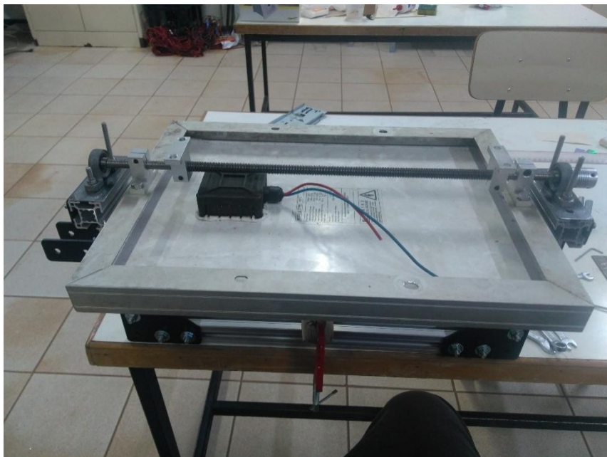
Figura 16 – Eixo vertical sustentado pelos mancais da estrutura em “U”. Fonte: Acervo do Autor.
