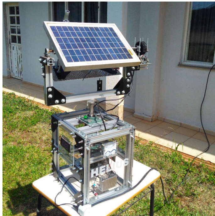
Figura 24 – Rastreador solar Helius em operação. Fonte: Acervo do Autor.
