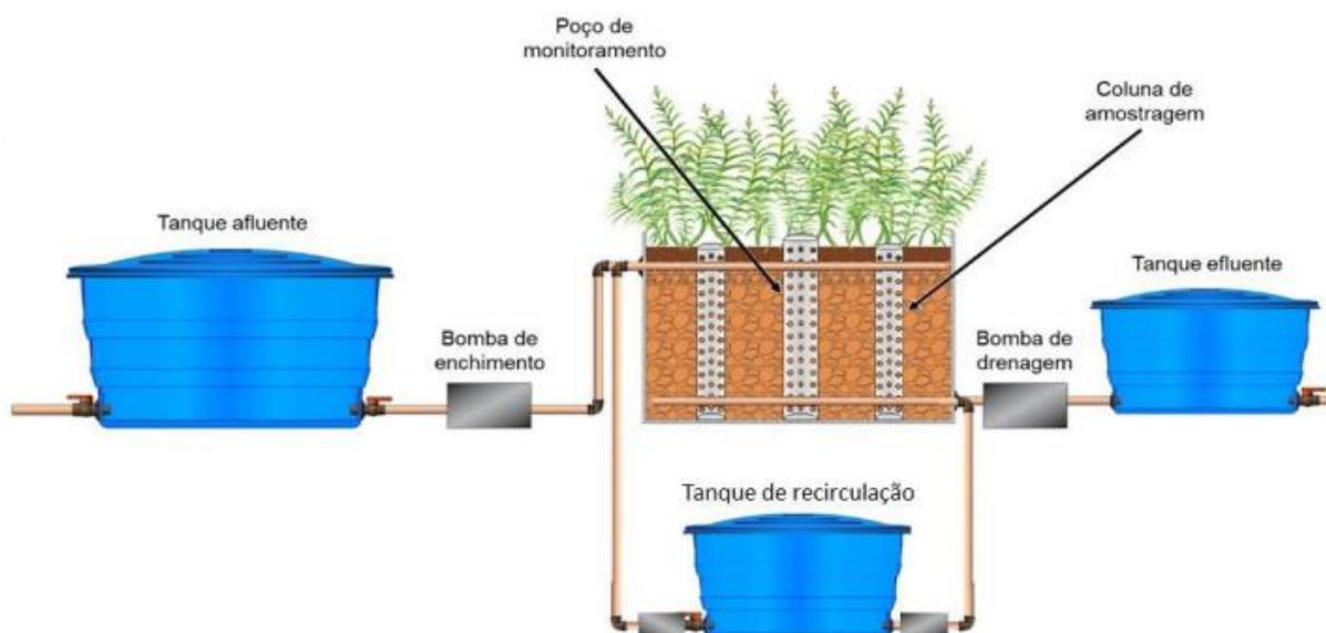
Figura 5 - Representação gráfica do sistema de WCTF.
