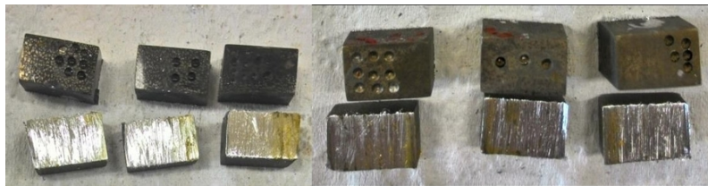
Figura 40 – Amostras serradas em seção transversal após período de corrosão
