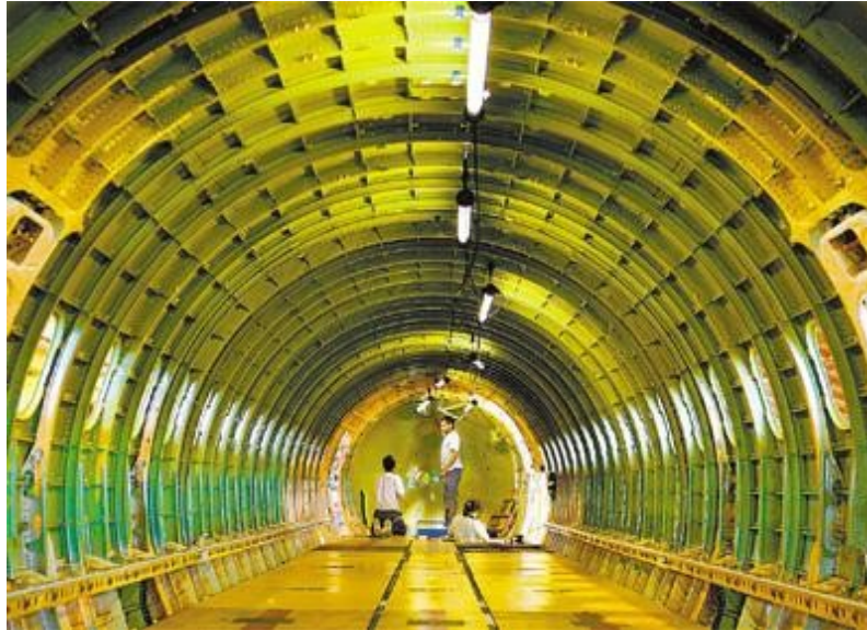
Figura 14 – Selagem da fuselagem para a pressurização da aeronave
