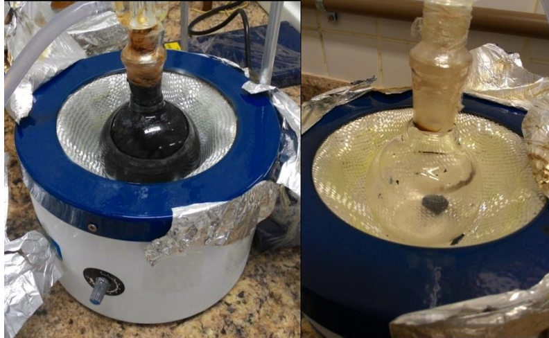
Figura 39 – Avaria no equipamento
