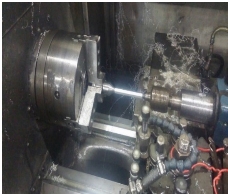
Figura 45 – (b) usinagem dos corpos de prova por torneamento
