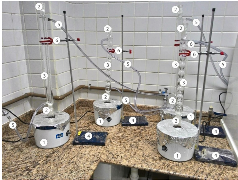
Figura 32 – Sistema de refluxo para simulação de corrosão.
