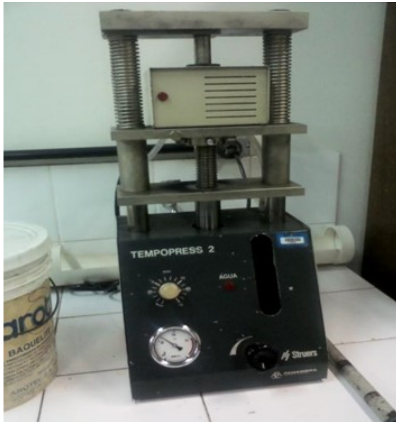
Figura 24 – Máquina utilizada para realização do embutimento
