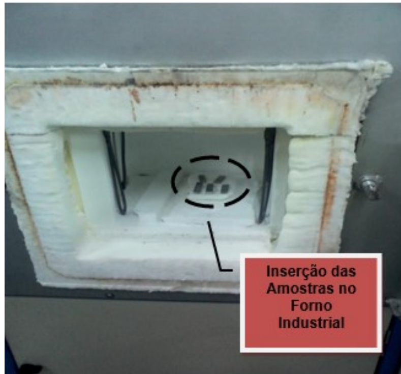
Figura 22 – Forno industrial utilizado no aquecimento das amostras
