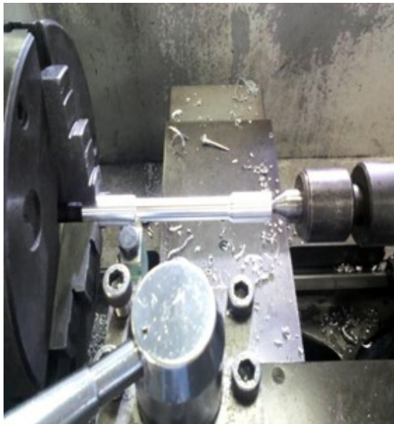
Figura 18 – a) Preparação e o corpo de prova pronto para o ensaio de tração
