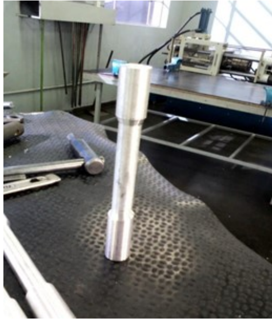
Figura 19 – b) Preparação e o corpo de prova pronto para o ensaio de tração
