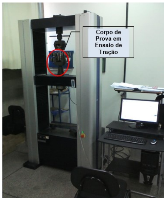
Figura 29 – Máquina utilizada para a realização do ensaio de tração
