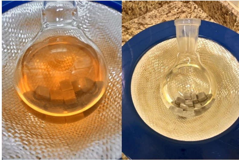
Figura 37 – Seis amostras nos balões com fluido de corte, à esquerda, e seis amostras no balão com água, à direita.
