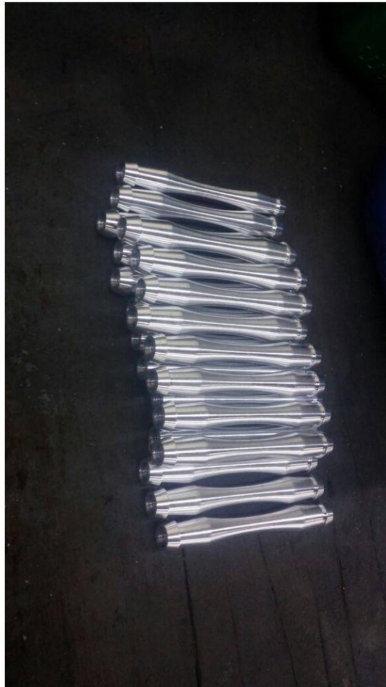
Figura 46 – 21 corpos de prova que foram usinados pelo torno CNC
