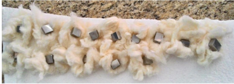
Figura 35 – Amostras polidas e prontas para serem inseridas no sistema corrosivo
