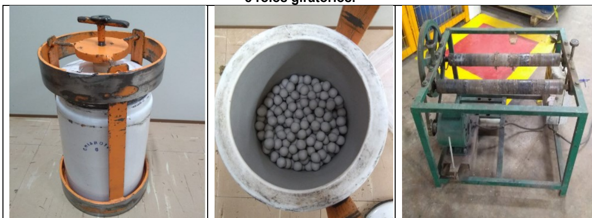
Figura 29 - Moinho de bolas constituído por a) jarro e ferragens b) bolas de alumina e c) motor e rolos giratórios.
