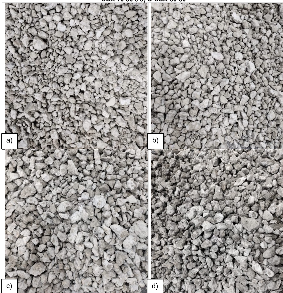
Figura 50 - Agregados tratados após o período de cura de 3 dias a) C-100 b) C-CCA-90-10 c) C-CCA-70-30 e d) C-CCA-50-50
