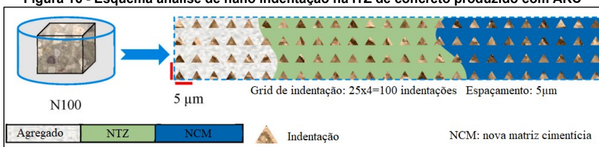
Figura 16 - Esquema análise de nano indentação na ITZ de concreto produzido com ARC
