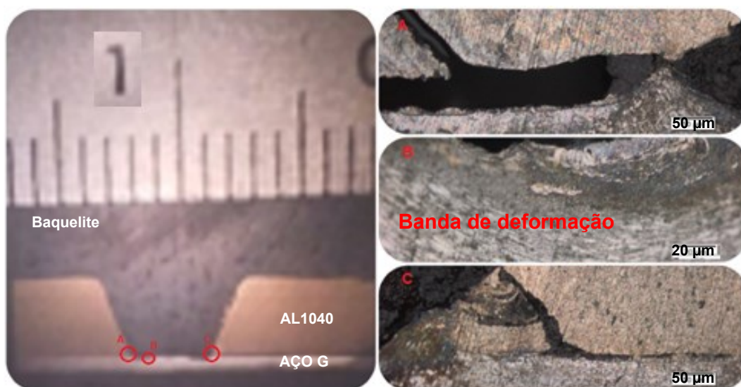
Figura 15 - Interface da soldagem na liga Al1040 no parâmetro de 1100 r.p.m.
