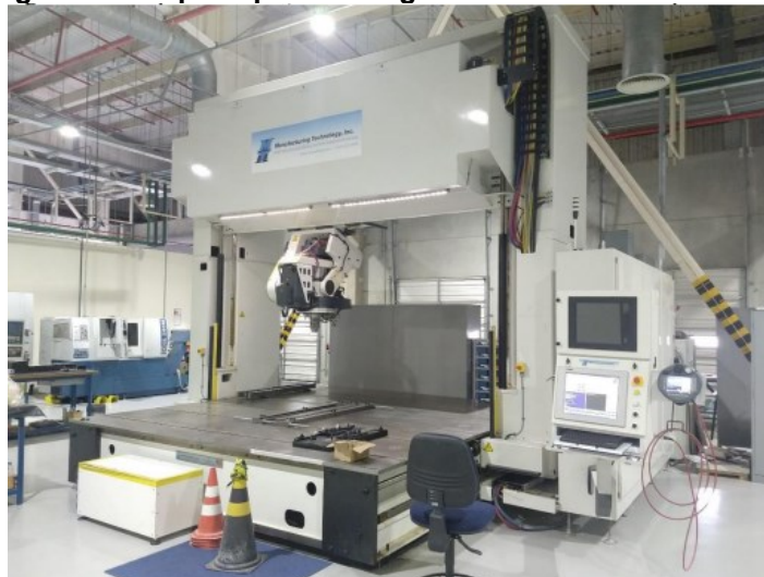
Figura 6 - Máquina para soldagem FSSW da marca Stirtec.
