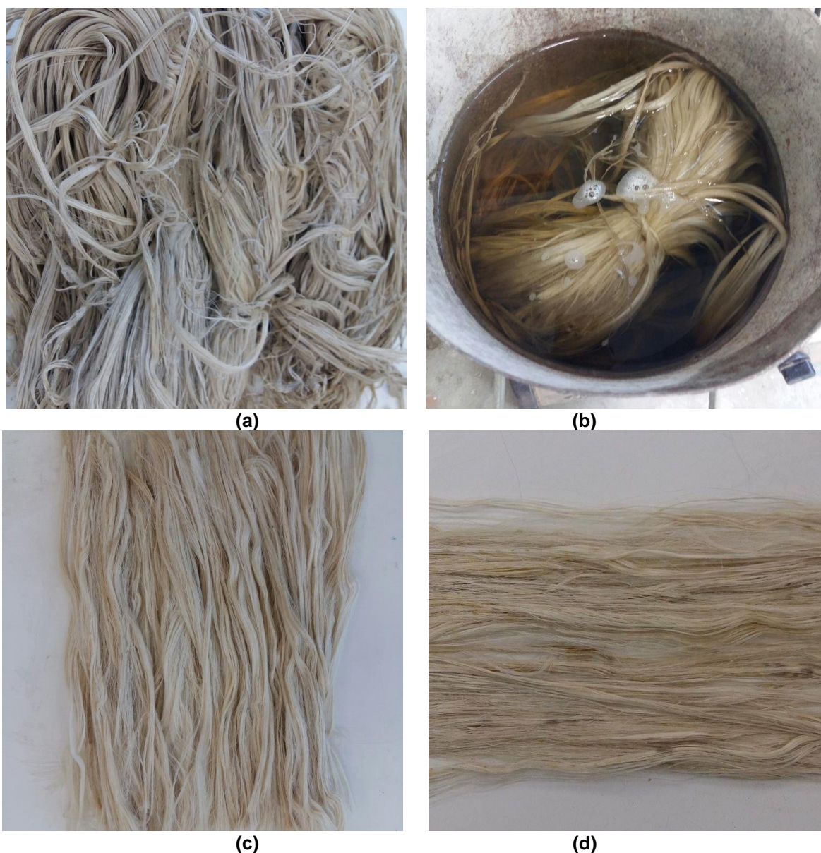
Figura 11 – Processo de beneficiamento da fibra de curauá: (a) fibras como foram recebidas; (b) fibras em imersão em água quente; (c) fibras após processo de preparação; (d) fibras cortadas e penteadas para o uso como reforço
