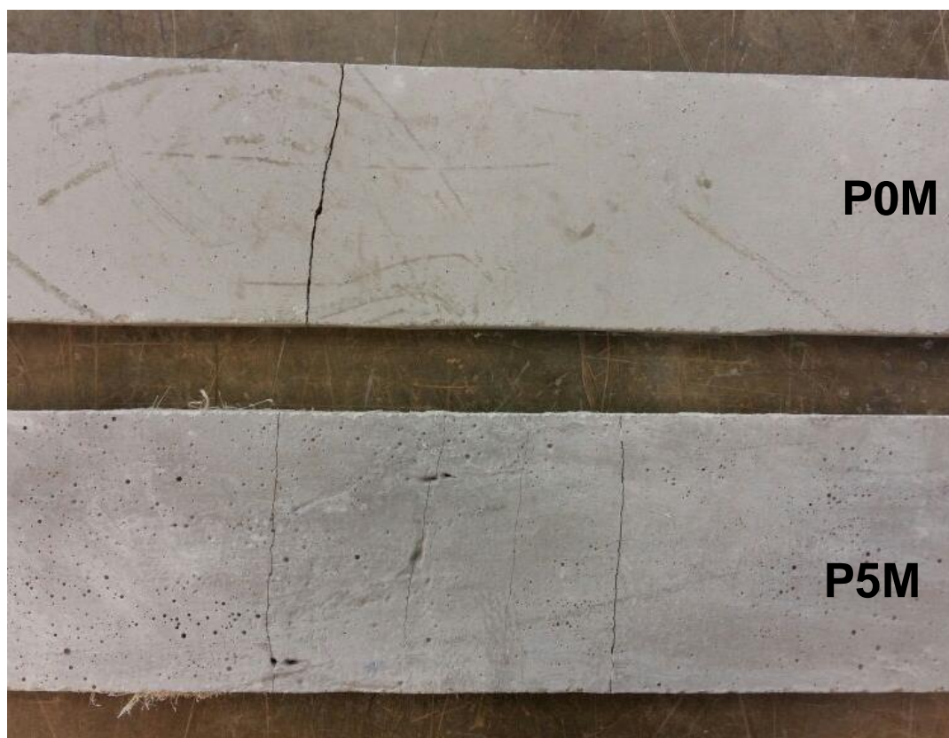
Figura 33 – Amostras de compósitos laminados após ensaio de flexão direta em 4 pontos Fonte: Autora (2017)
