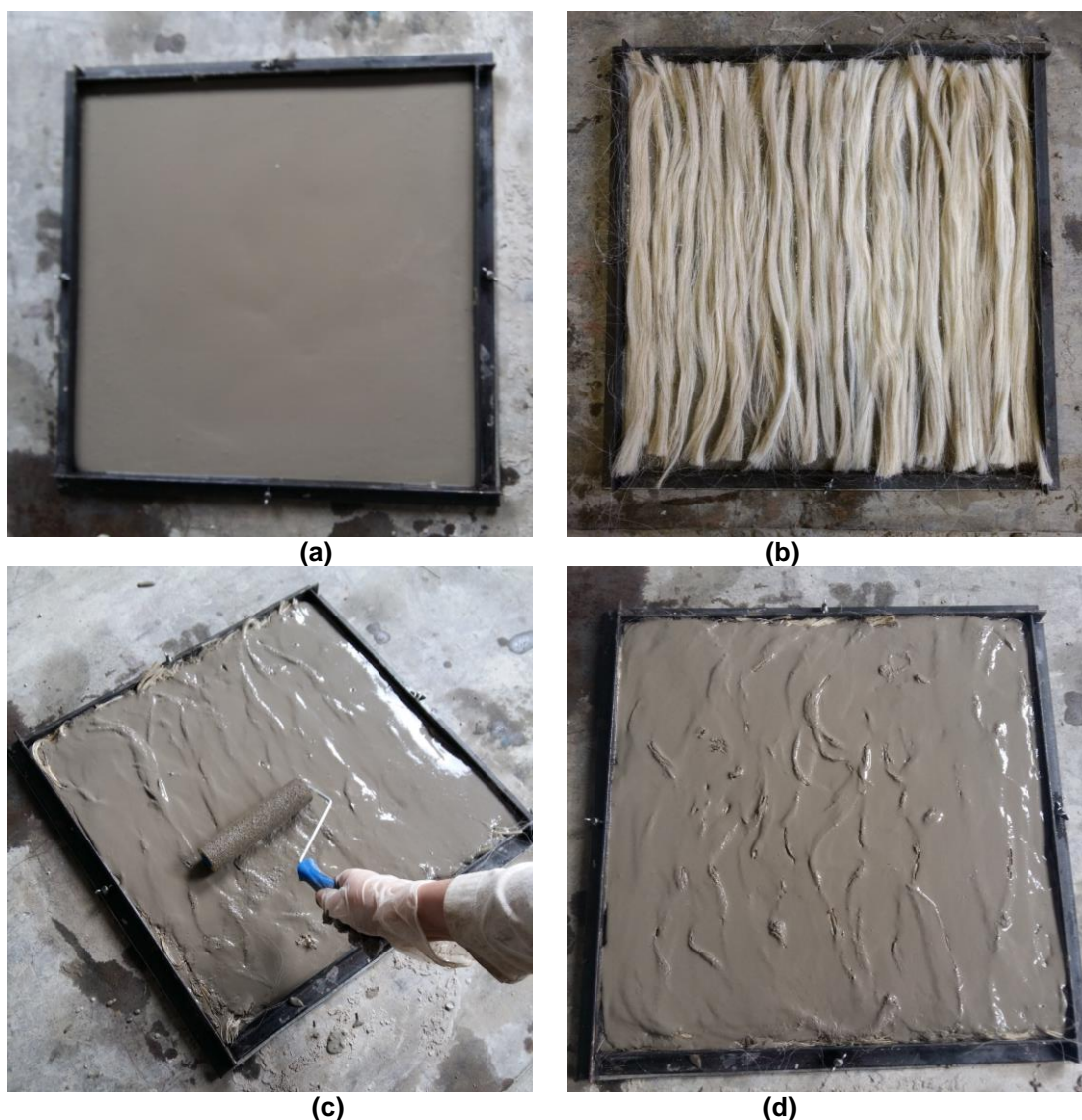
Figura 21 – Produção dos compósitos laminados: (a) primeira camada da matriz; (b) primeira camada de fibra de curauá sobre a matriz; (c) homogeneização da segunda camada da matriz com ajuda de um rolo; (d) moldagem finalizada pronta para vibração Fonte: Autora (2017)
