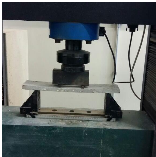
Figura 23 – Ensaio de flexão em 4 pontos Fonte: Autora (2017)
