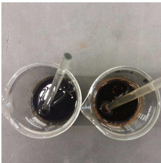
Figura 14 – Fibra em solução com ácido sulfúrico Fonte: Autora (2017)
