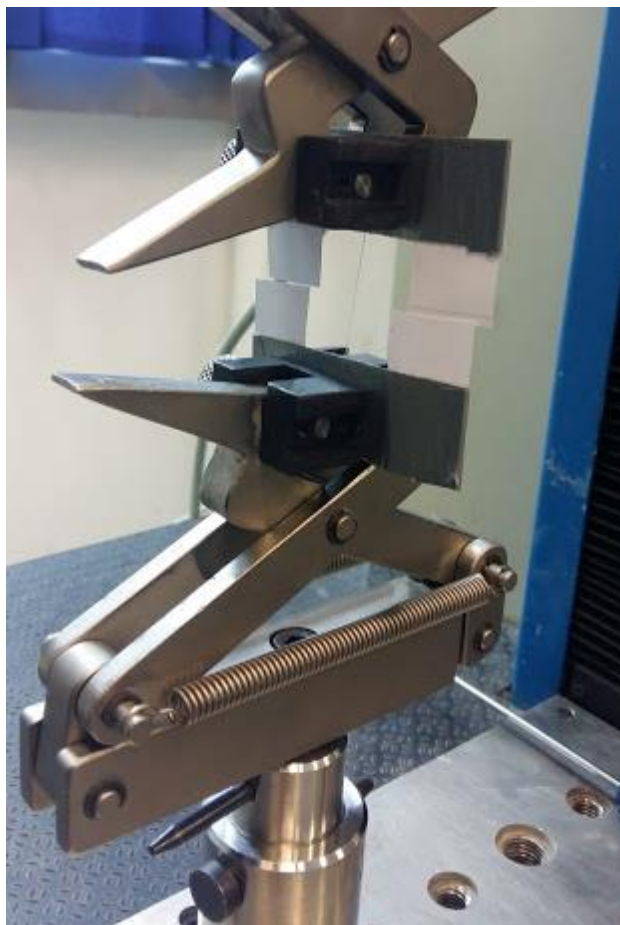
Figura 17 – Ensaio de resistência à tração da fibra de curauá Fonte: Autora (2017)
