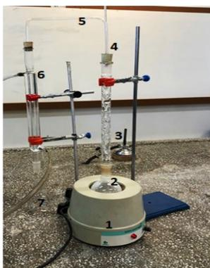
Legenda: 1 - manta aquecedora elétrica, 2 - balão de fundo redondo, 3 - coluna de Vigreux, 4 - termômetro, 5 - cano de vidro em formato de U, 6 - destilador de Liebig, 7 - erlenmeyer
